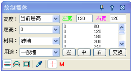
图 4-1 “绘制墙体”对话框
