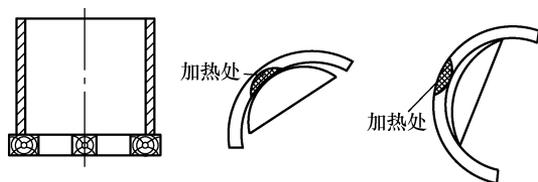
图 6-6 厚壁筒体的火焰矫正示意图
