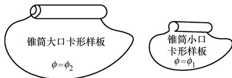
图 2-11 锥筒弯曲加工样板
