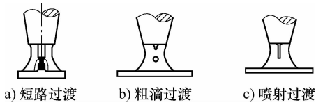
图 3-70 熔滴过渡的三种基本形式
