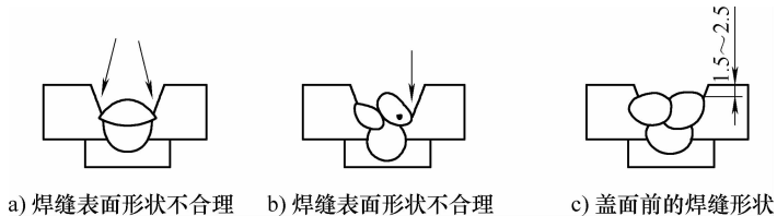
图 3-77 多层焊时要注意的地方
