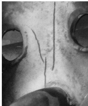
图 5-7 某锅炉炉胆因焊接残余应力开裂
