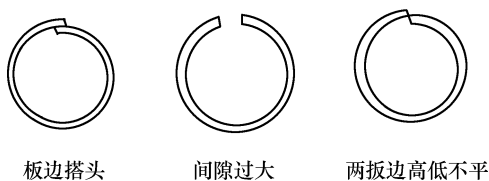
图 5-44 滚制圆筒常见的缺陷
