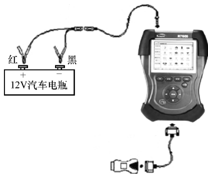
图 22 汽车诊断座的连接
