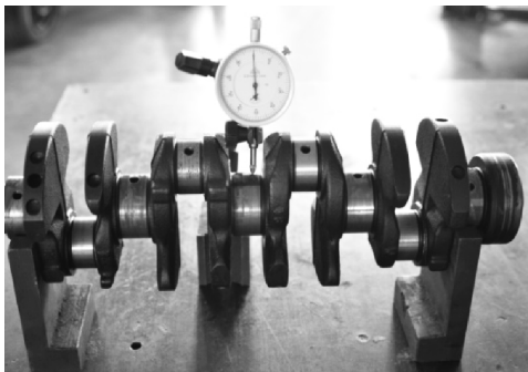
图 38 曲轴弯曲的检测
