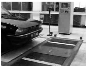
图 20 汽车低速通过滑动板
