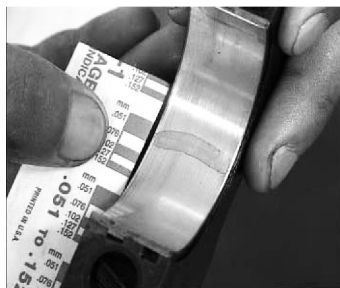
图 18 轴承盖宽度测量
