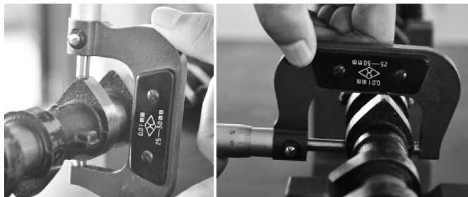
图 37 凸轮磨损的检测
