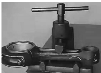
图 36 连杆弯曲的校正
