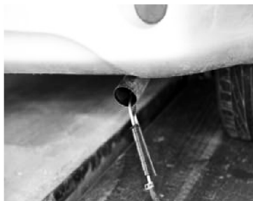
图 10 将取样管和探头插入排气管
