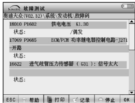
图 30 故障码的读取
