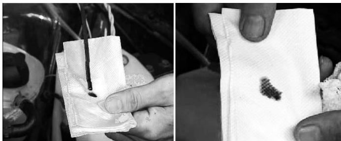
图1 机油颜色的检查
