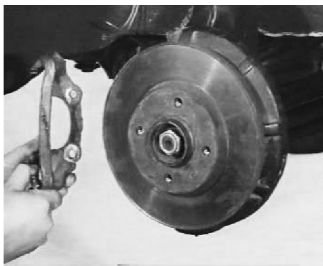
图 40 取下制动钳支架
