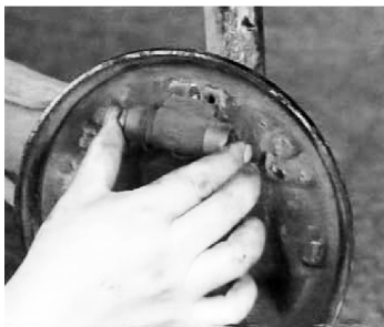
图 45 拆卸制动分泵
