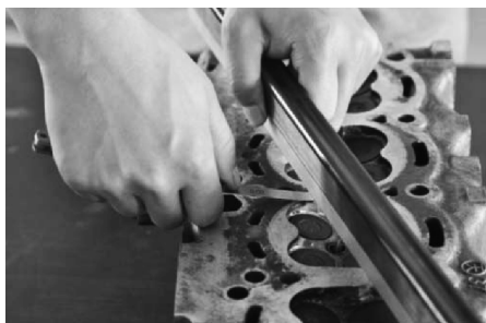
图 32 气缸盖下平面度的检测
