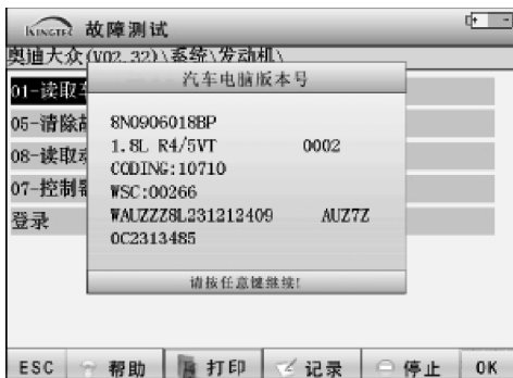
图 29 汽车电脑版本号的读取
