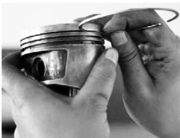
图 15 活塞环背隙检查
