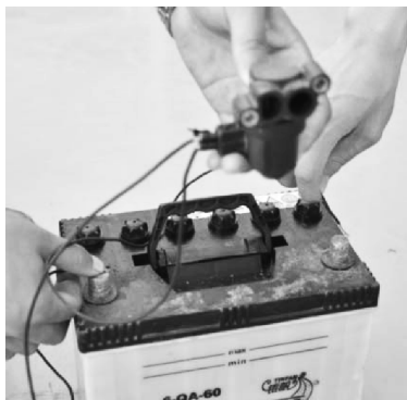
图 39 怠速控制阀的检测
