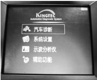
图 25 诊断系统的进入
