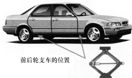
图 9 用千斤顶顶起轿车
