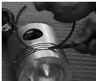
图 14 用塞尺检查活塞环边隙
