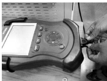
图 23 测试延长线的连接
