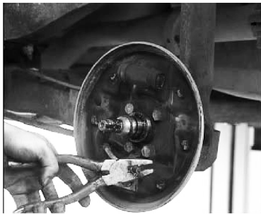
图 44 拆卸制动拉索
