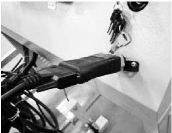
图 24 测试接头与诊断座的连接
