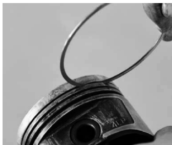
图 13 活塞环边隙检查
