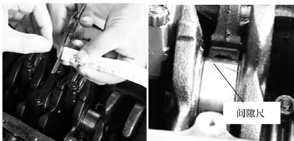
图 17 曲轴轴承间隙检查
