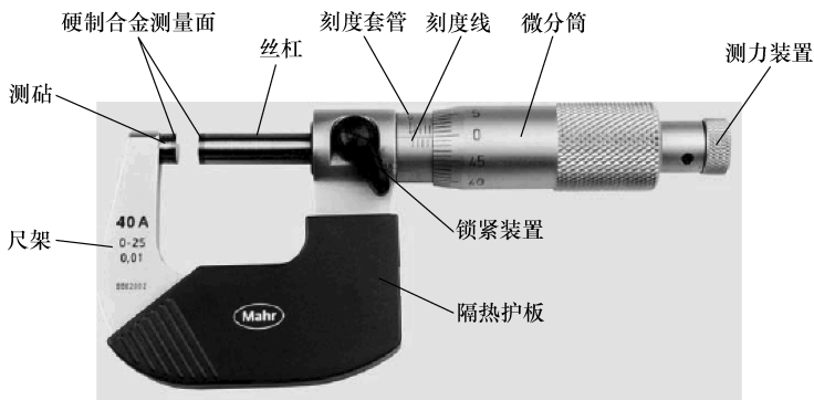
图 1-54 千分尺的结构
