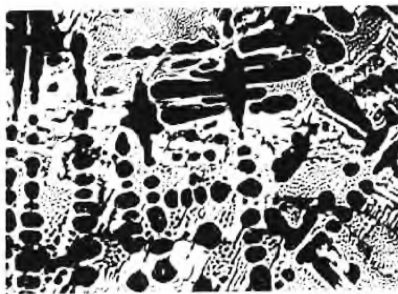
图 1-13 亚共晶白口铸铁的室温平衡状态显微组织
