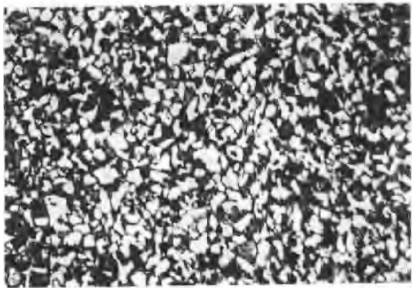
图 1-7 碳质量分数为 0.4% 的亚共析钢的室温平衡状态显微组织
