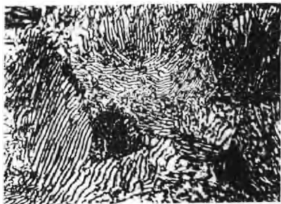
图 1-5 共析钢的室温平衡状态显微组织
