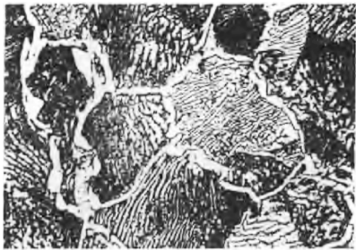
图 1-9 碳的质量分数为 1.2% 的过共析钢的室温平衡状态显微组织
