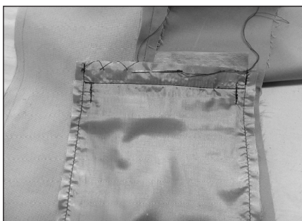
⑰ 将袋布上沿用三角针绷缝于前片内侧粘衬上，注意衣片正面不露针迹。
