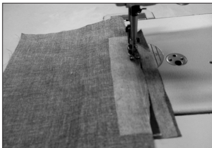
⑩ 掀起下侧衣片，沿嵌条车缝线缉缝，固定嵌条和衣身缝头。
