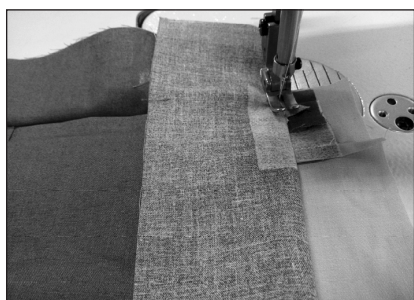
⑯ 放平、整理好衣片、嵌条、袋布及小三角布，缉缝固定小三角。缉缝时注意袋口位的平服，并车缝3~4道缝线。
