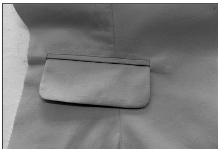
⑨ 将袋盖插入袋口，调整位置，对合标记线，注意不要将袋盖放错衣片，定位。
