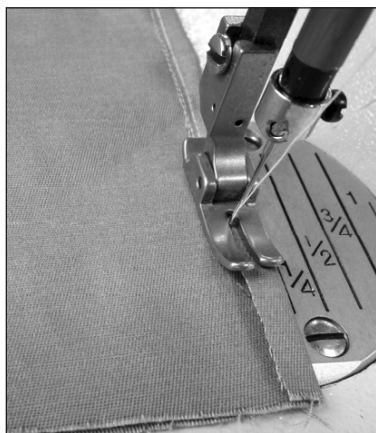
② 将下层布料缝边包转到上层，距毛边0.1cm缉一道缝线。
