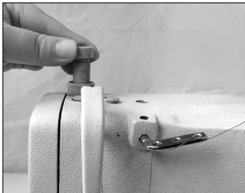
图4-4-13 压脚压力调节螺钉
