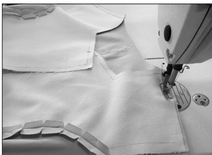
① 前后衣身正面相对，前片在上，后片肩缝略吃，缝合肩缝。
