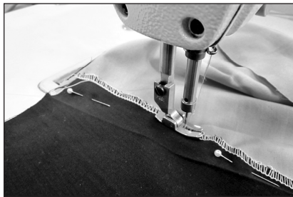
⑧ 打开插袋口裤片折边，沿锁边线内沿缉缝，固定折边和上层袋布。
