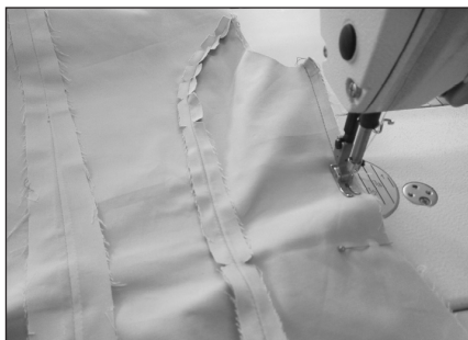
③ 前后衣身正面相对，前片在上，缝合侧缝。
