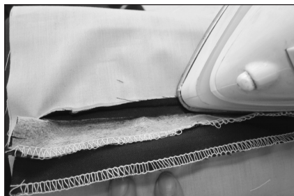
⑨ 在裤片反面将剪开的开袋缝份分烫。
