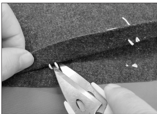
⑥ 将剪刀平伸入衣片间，剪断线钉。
