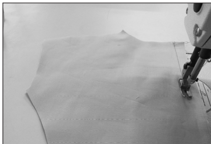
② 后片正面相对，缝合后中缝。
