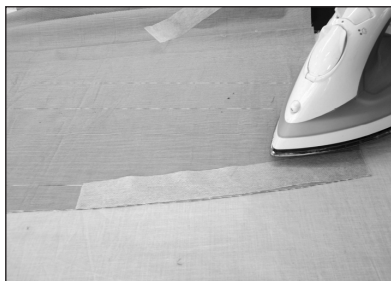
② 在裙侧缝上拉链处布料内侧，自腰线向下粘2cm宽、22cm长薄型粘合衬。
