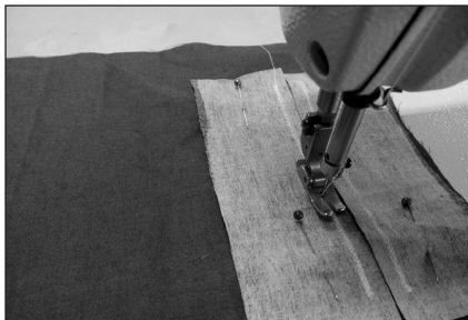
④ 按缉缝线车缝上下两道线，注意起止回针，且两线要平行。
