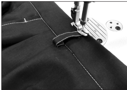
⑨ 将裤裆折向腰头上口，裤裆上端折进0.7cm缝份，车缝做回针3~4次，与腰头固定。
