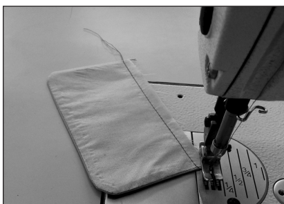
⑦ 距上袋盖一边0.5cm处缉缝，稍拉紧里布，固定袋盖面、里，形成窝势。
