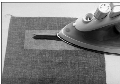
⑦ 在衣片反面，分烫下侧缉缝嵌条和衣片的缝份。
