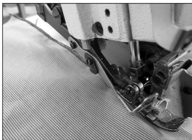
① 将裙前片、裙后片侧缝锁边。
