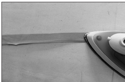
① 将斜条一侧布边扣烫0.5cm缝份。
