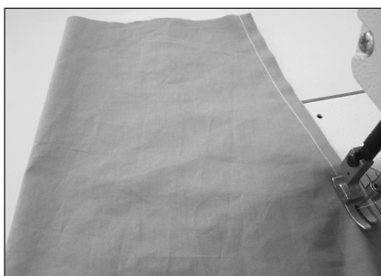
① 对合衣片、袖身，对齐袖底十字缝口，在衣身反面缉缝，缝份为1cm。
