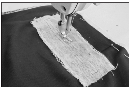
⑥ 距袋口线0.5cm，上下各缉缝一条和袋口等长的线，要求两条线平行，注意缝线两端要做回针处理。
