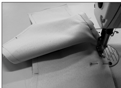
④ 前片和前侧片正面相对，前片在上，对齐对位点，缝合刀背缝。
