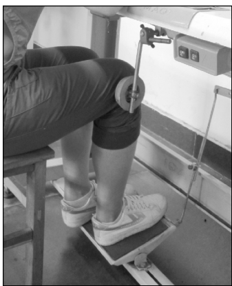
图4-4-2 膝控抬压脚装置位置及 缝制操作时双脚位置
