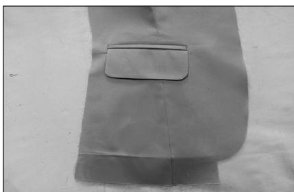
⑰ 将袋布上沿用三角针绷缝于前片内侧粘衬上，注意衣片正面不露针迹。
