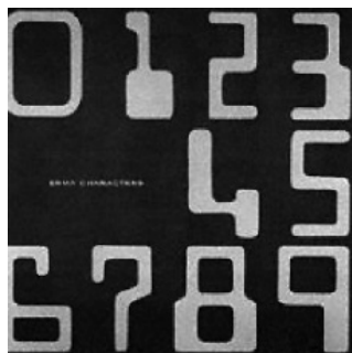
图1-4 ERMA系统采用的磁墨水字符
