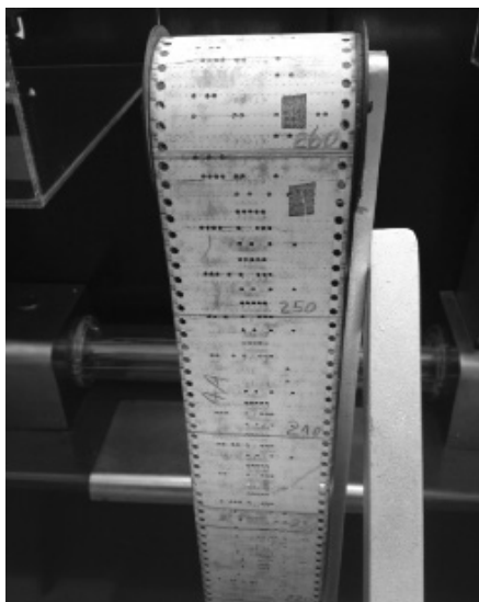
图1-3 Harvard Mark I采用的 打孔纸带
