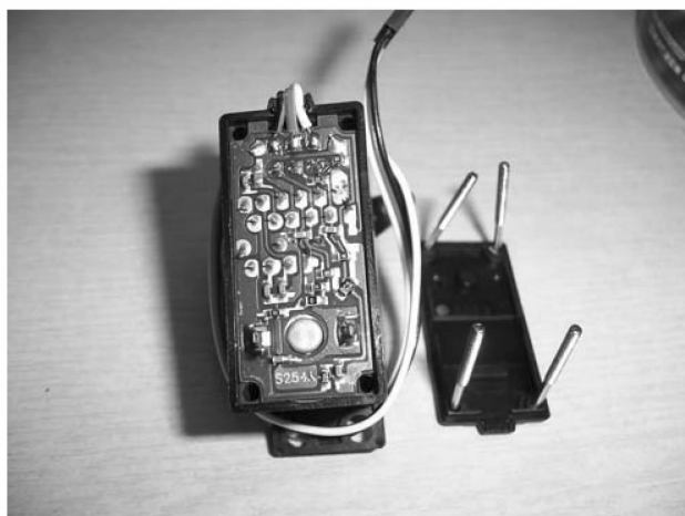
图 4-20 拆除底盖后的舵机
