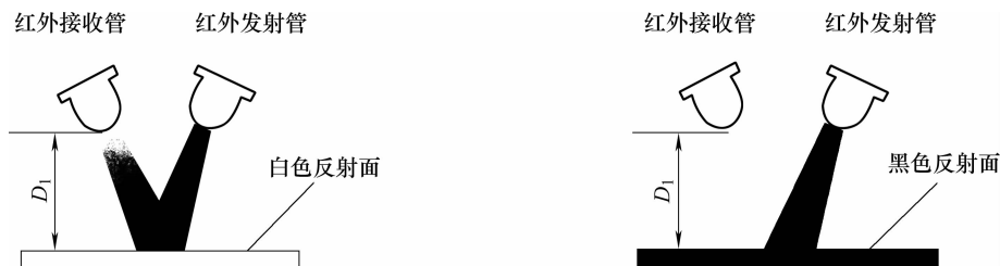
图 5-7 红外传感器地面颜色识别原理
