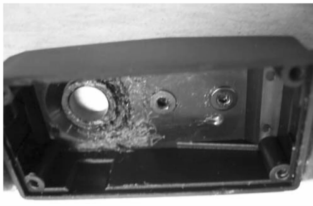
图 4-19 拆除限位齿的舵机顶盖
