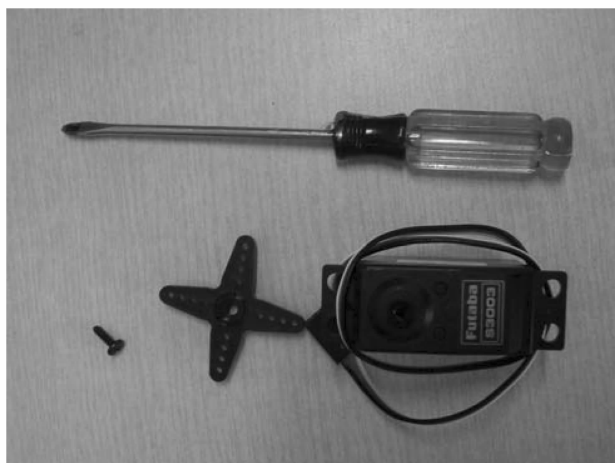
图 4-12 拆掉舵盘的舵机和小螺钉旋具
