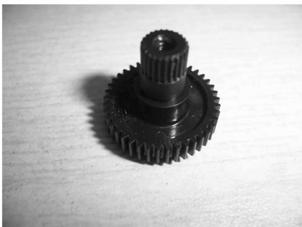
图 4-17 拆除限位的舵机止动齿
