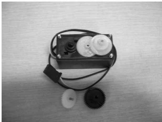
图 4-15 拆掉的花键齿轮
