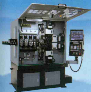
CK940、CK960、CK9100 九轴数控弹簧成形机 Wire Diameter(mm): \phi 1.0~9.0
