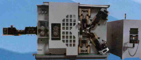
CK690、CK6120、CK6160、CK6180、 CK6200 各型号六轴数控弹簧成形机 Wire Diameter(mm): \phi 3~20
