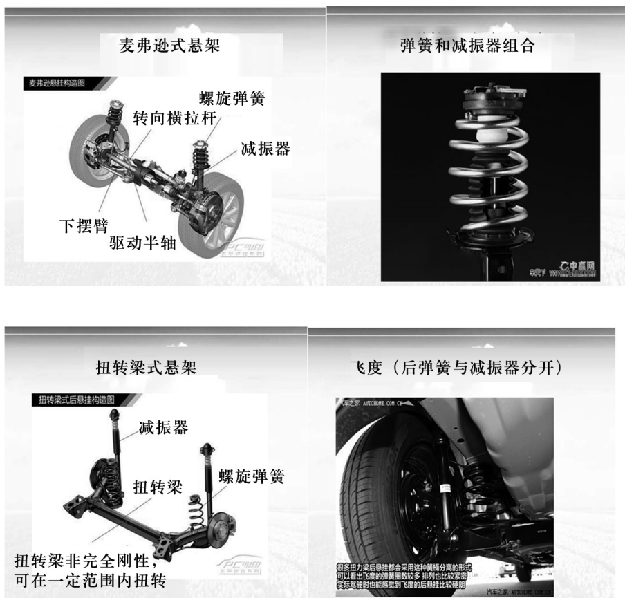
图1 各种形状的悬架弹簧及其安装示意图
