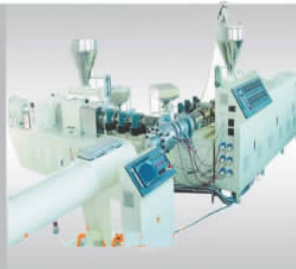
PVC管材生产线 ( \phi 16 \sim 630\text{mm} )
