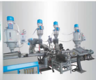
高速铝塑复合管生产线 ( \phi 16 \sim 63\text{mm} )
