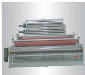
土工膜/防水卷材生产线 (宽 \leq 7\text{m} )
