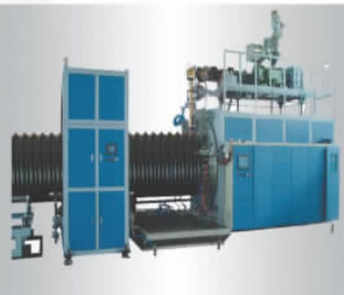
PE/PP螺旋波纹管生产线 ( \phi 200 \sim 2000\text{mm} )
