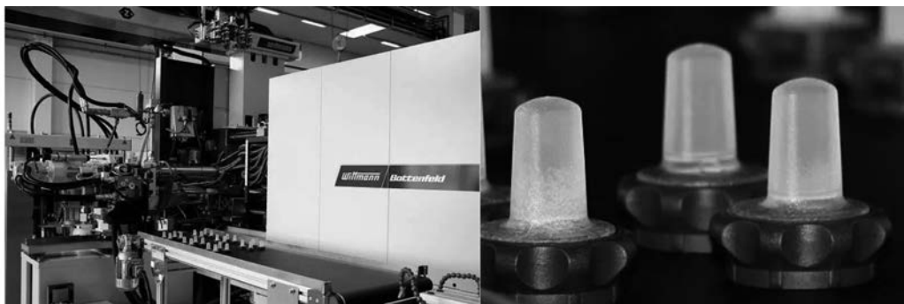
图6 威猛巴顿菲尔的热塑性塑料和液态硅胶制成的饮用盖生产单元
