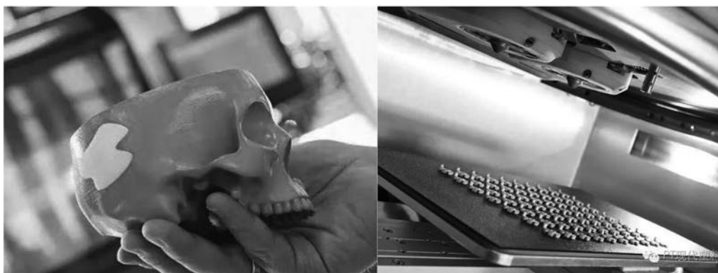
图7 阿博格 Freeformer 打印的颅骨植入物及耐高温 PEI 材料制品
