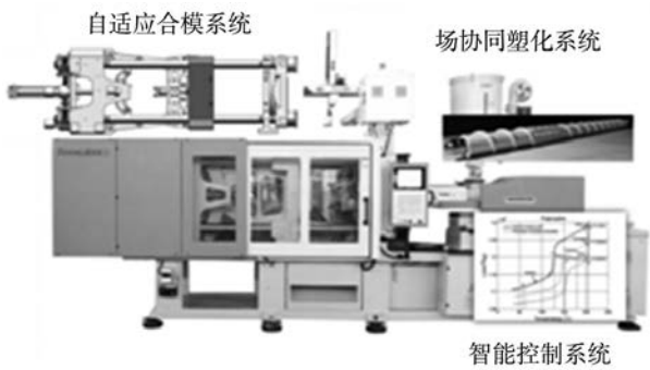
图 5 第二代精密三板式注塑机
