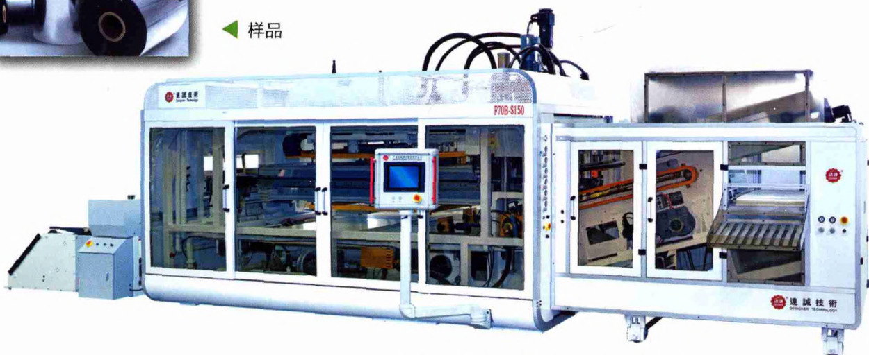
▲ 全自动塑片气压热成型机 (配翻转膜)
