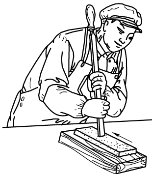
图 9-21 刃磨刮刀顶端方法（二）
