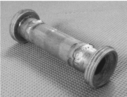
图 18.5 内表面涂覆钎料的试样
