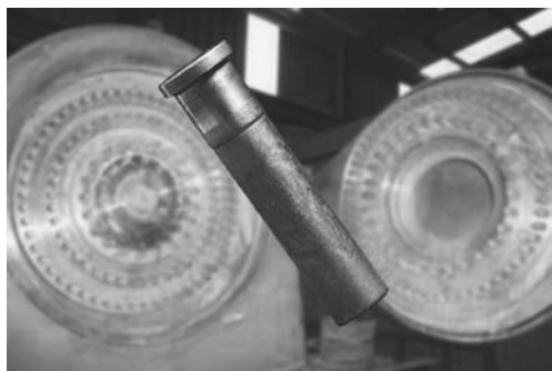
图 15.18 钎涂销钉的销钉辊轧机
