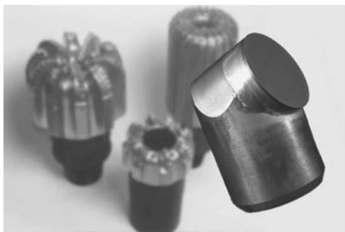
图 15.8 石油和天然气钻探工具上的钎焊 PCD 切削头（WEG, 2008）
