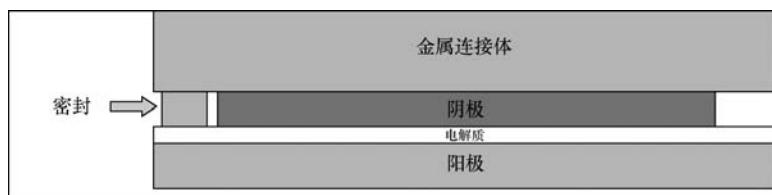
图 17.1 固体氧化物燃料电池 (SOFC) 装配示意图 (图中尺寸未按实际比例绘制)
