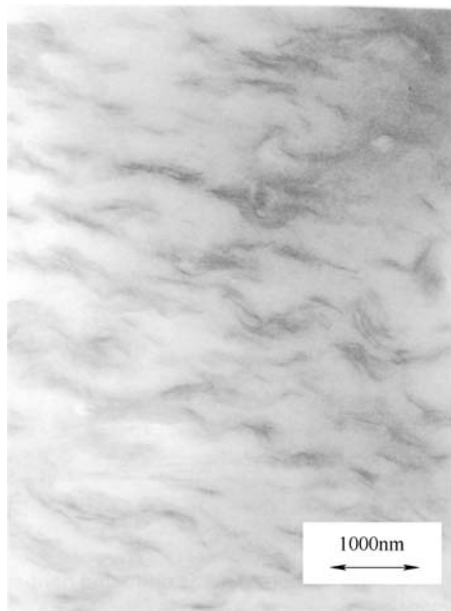
图 11.11 处理后的蛋白质/甘油/水/蒙脱石钠样品的 TEM 图像
