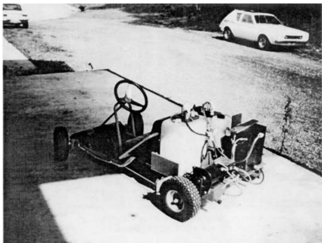
图 A1.7 早期满流电解液铁氧化还原电池驱动动力演示——高尔夫球车, 大约在 1974 年部分提供不间断的电源。总的能量容量大约是 20\text{kW} \cdot \text{h} 。
