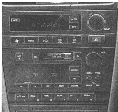
图 3-1-22 考虑手部操纵范围的开关布置
