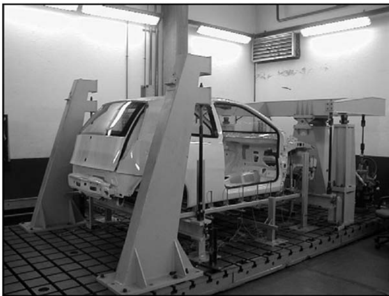
图 12-68 扭转刚度测量试验台
