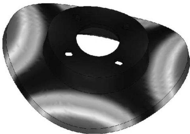
图 11-38 带有两条正交节点线的制动盘的振型
