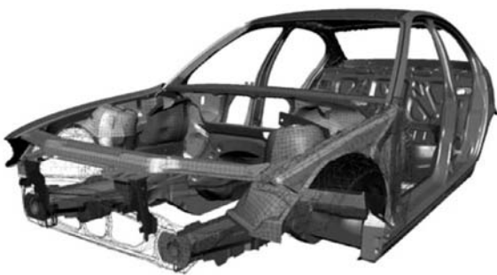
图 12-64 车身结构的详细有限元模型。
