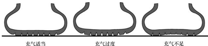
图 3.40 轮胎充气过度、充气不足与充气适当时的轮胎-路面接触情况比较
