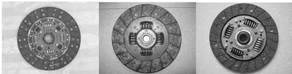
图 1-17 分体波形片、整体波形片和预减振等不同结构从动盘总成
