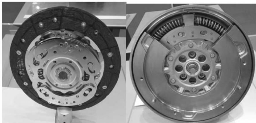
图 11-14 离心摆结构的从动盘总成和双质量飞轮
