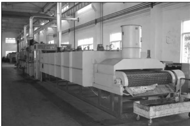
图 6-5 双工位全自动膜片淬火成形机及清洗回火生产线（AICHELIN）
