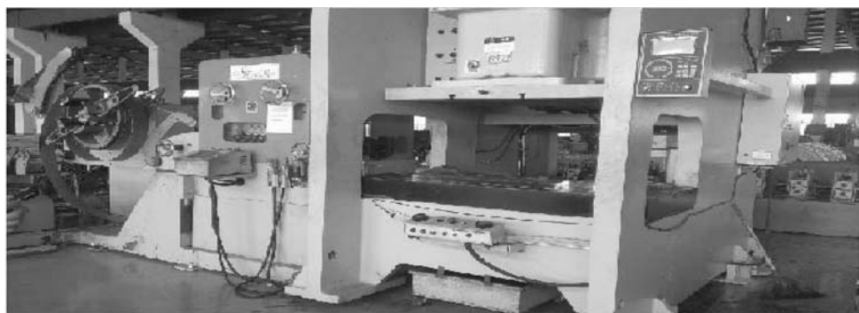
图 11-27 自动开卷机与多工位压力机实例
