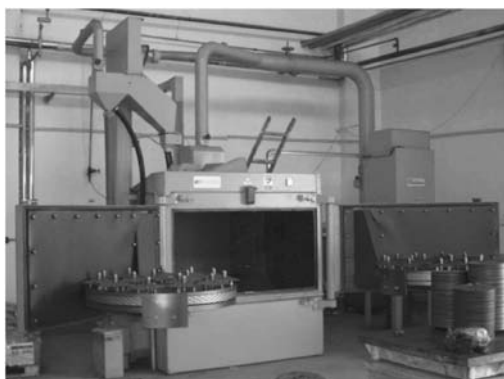
图 6-10 靠高速旋转叶轮的 离心力抛射弹丸设备 (SISSON)
