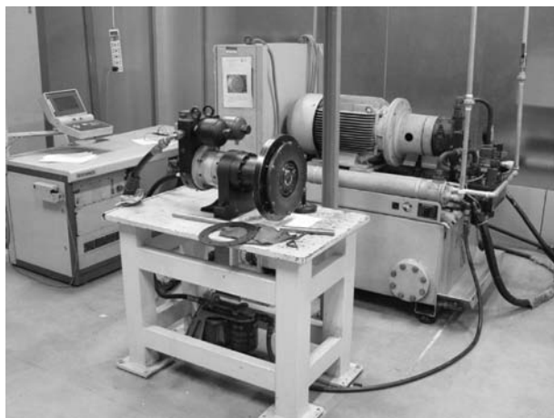
图 6-32 扭转特性及疲劳试验机
