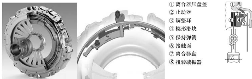
图 11-7 SACHS 自调整离合器 X-TEND 结构
