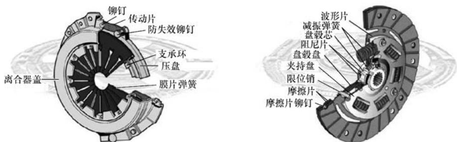
图 1-14 膜片弹簧离合器构造简图
