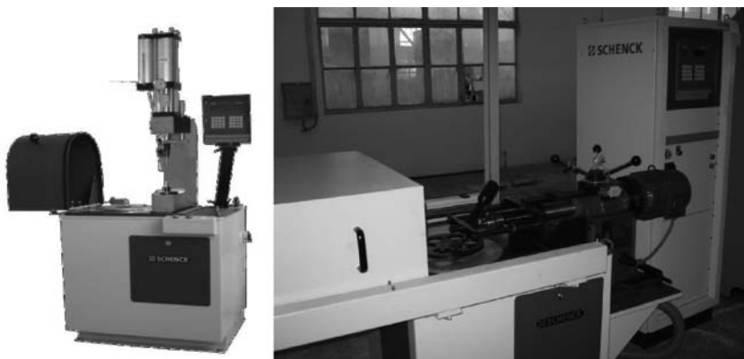
图6-23 钻孔去重或铆压平衡块与平衡机集成方案
