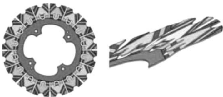
图 4-48 Tripod 波形片 (每种颜色对应不同高度)
