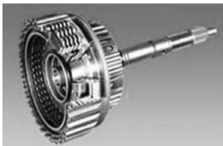
图 11-22 湿式多片式液力离合器
