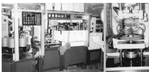
图 6-8 感应加热膜片淬火成形机 (GH/汉阳高周波/EFD)
