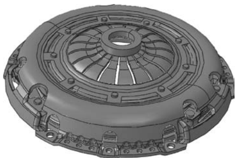
图5-2 某型离合器简化的离合器总成 (包括分离轴承)的几何模型
