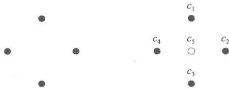
图 6.1 左图：4 个点被平行于轴的矩形打散。右图：任何平行于轴的矩形都不能在将其他点标记为 1 的情况下将 c_5 标记为 0
