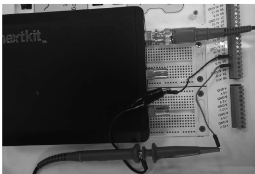
图 12.17 单机数据采集系统的硬件实物图
