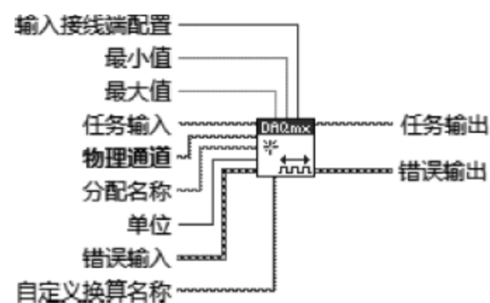
图 10.22 采 DAQmx 创建虚拟通道函数节点的图标和端口
