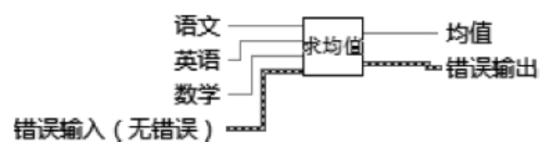
图 3.69 加错误簇函数后的子 VI 接线显示
