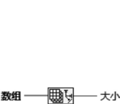
图 3.38 “数组大小”函数的图标和端口
