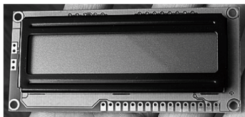
图 7-1 标准型 1602 液晶显示字符模块实物图
