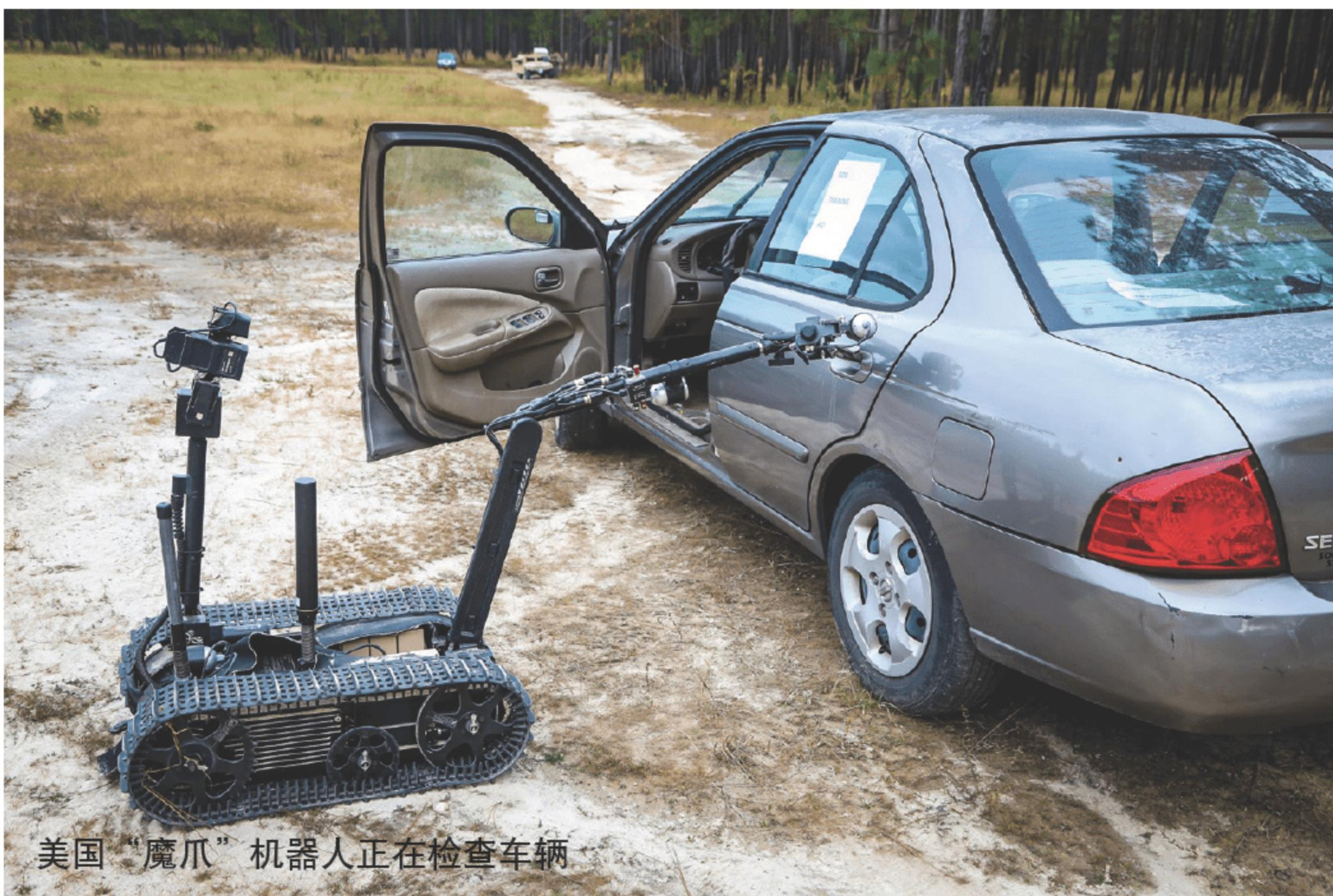
美国“魔爪”机器人正在检查车辆
