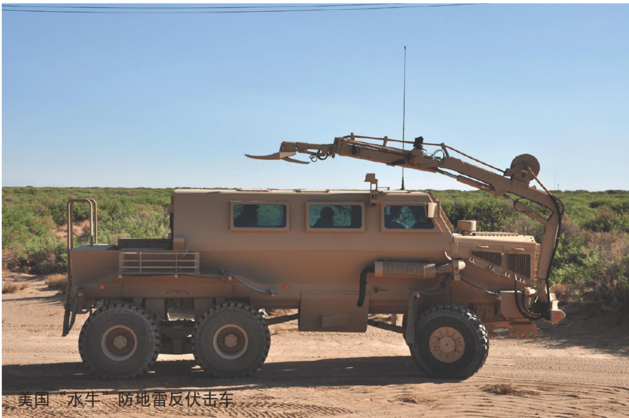
型在细节设计上虽各有差异，但整体设计思想基本相同。它们大多基于成熟越野汽车底盘改装，能够有效提高车辆总成部件通用化水平，降低维修保障费用。这些车型大多采用V形底部结构，并以4×4驱动车型为主，而后又发展了6×6、全地形车型，满足了部队对于更大承载能力、更好机动能力的需求。同时，各国注重车族化发展，基于基型车开发了运兵车、巡逻车、运输车、救护车、特种作战车、抢救车等车型。
