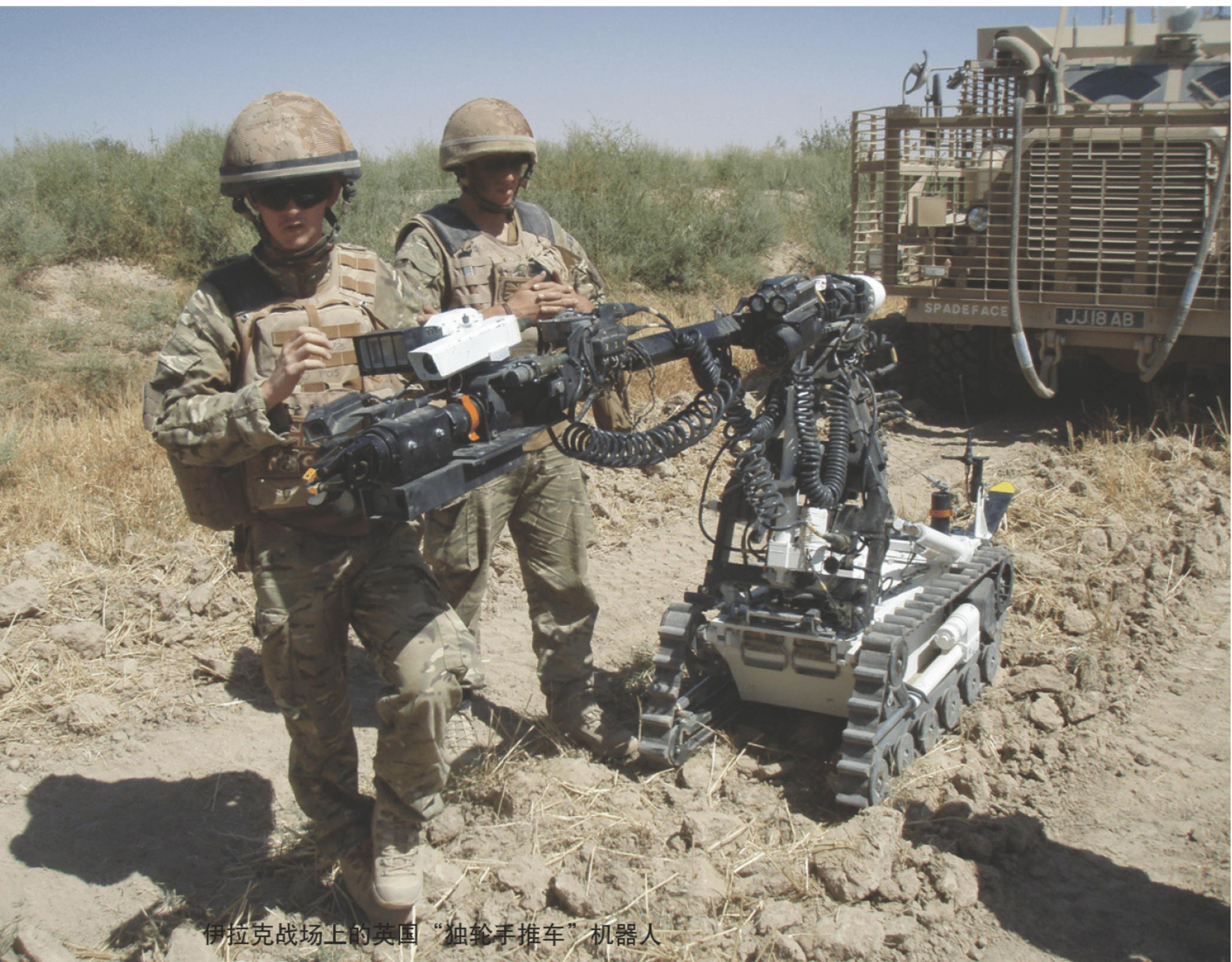
伊拉克战场上的英国“独轮手推车”机器人
