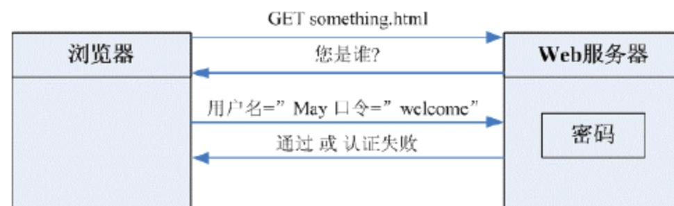
图 10-3 质询-响应安全机制
