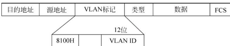
图 2.10 带 VLAN 标识符字段的 MAC 帧格式(802.1Q)
