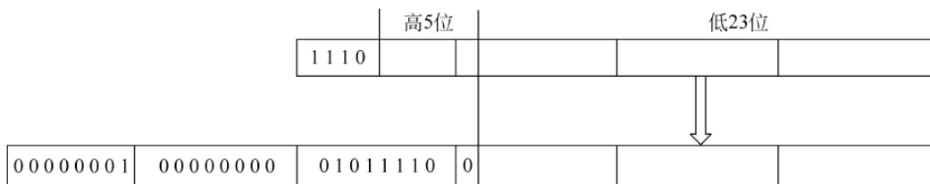
图 7.8 IP 组播地址映射到 MAC 组地址的过程
