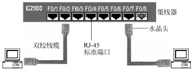
图 1.14 集线器互连终端示意图
