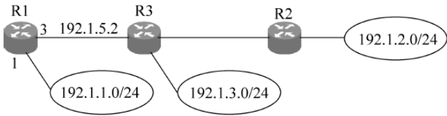
图 6.5 以路由器 R1 为根的最短路径树
