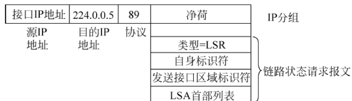
图 6.17 链路状态请求报文格式
