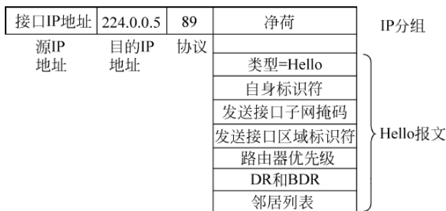
图 6.14 Hello 报文格式和封装过程
