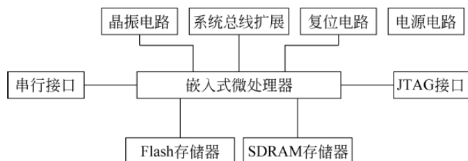
图 4-1 嵌入式最小系统原理图
