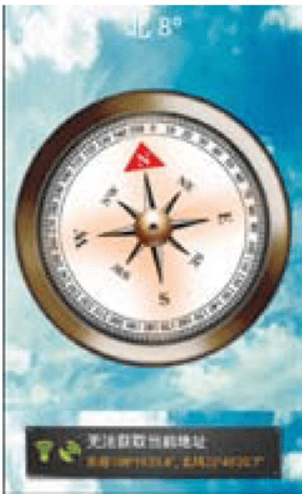
图2-12 磁阻传感器在手机中实现的电子罗盘
