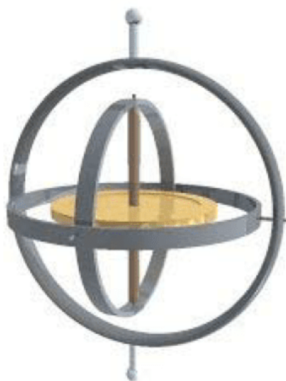
图2-8 三轴陀螺仪三维结构图
