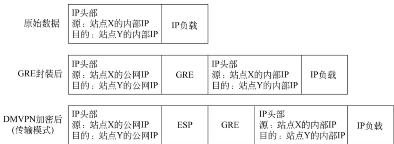
图 3-34 DMVPN 封装示意图
