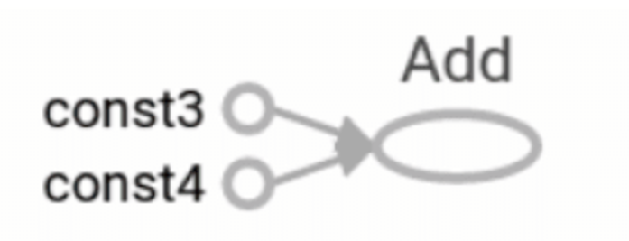
图 8-10 常数节点加法操作计算图
