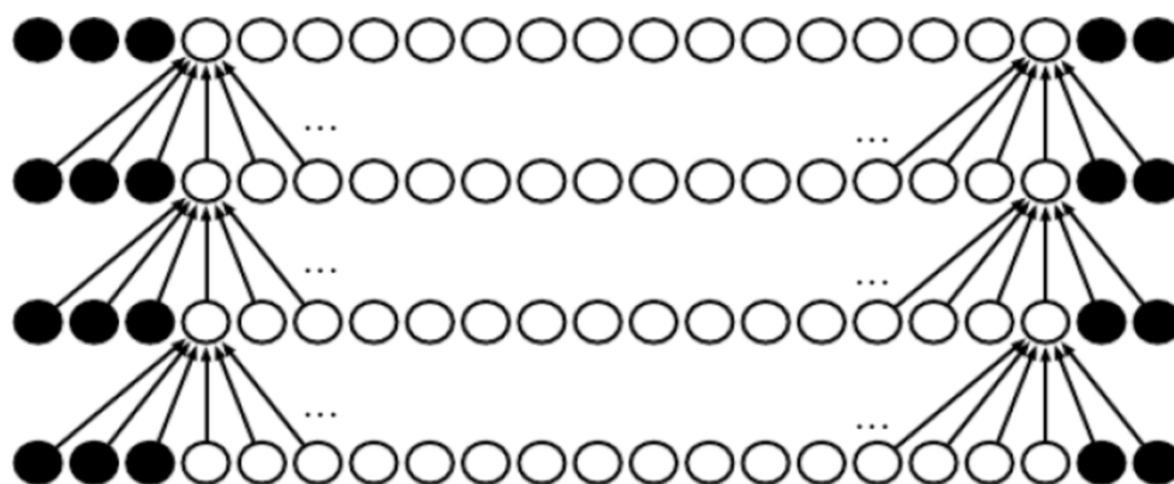
图 6-10 零填充卷积网络示意图
