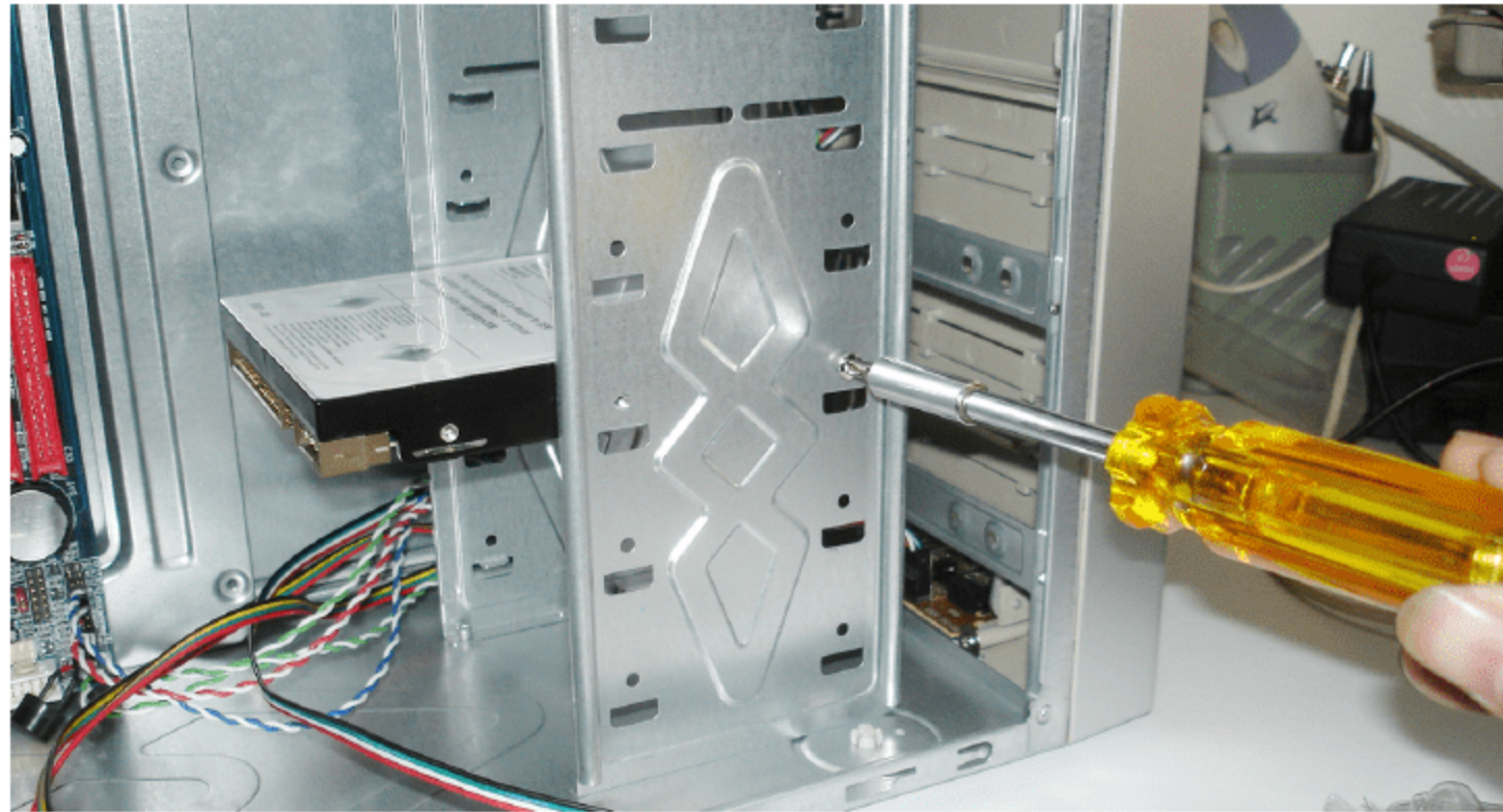
图 2.53 用螺丝固定硬盘
