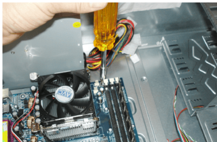
图 2.34 拧紧螺丝以固定主板
