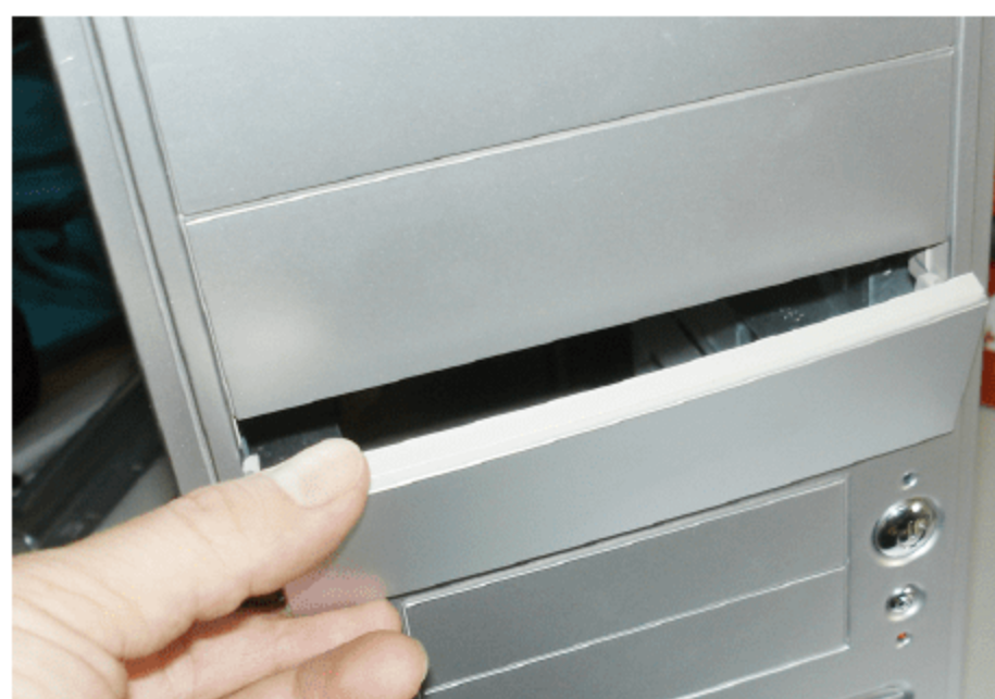
图 2.70 再拆开一块机箱的塑料挡板
