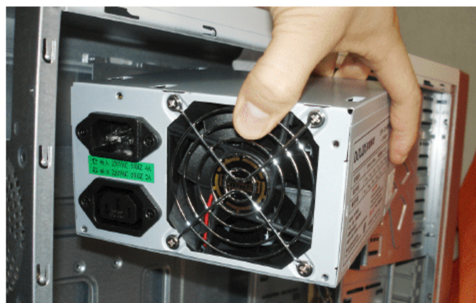
图 2.24 把电源放进机箱中指定的位置
