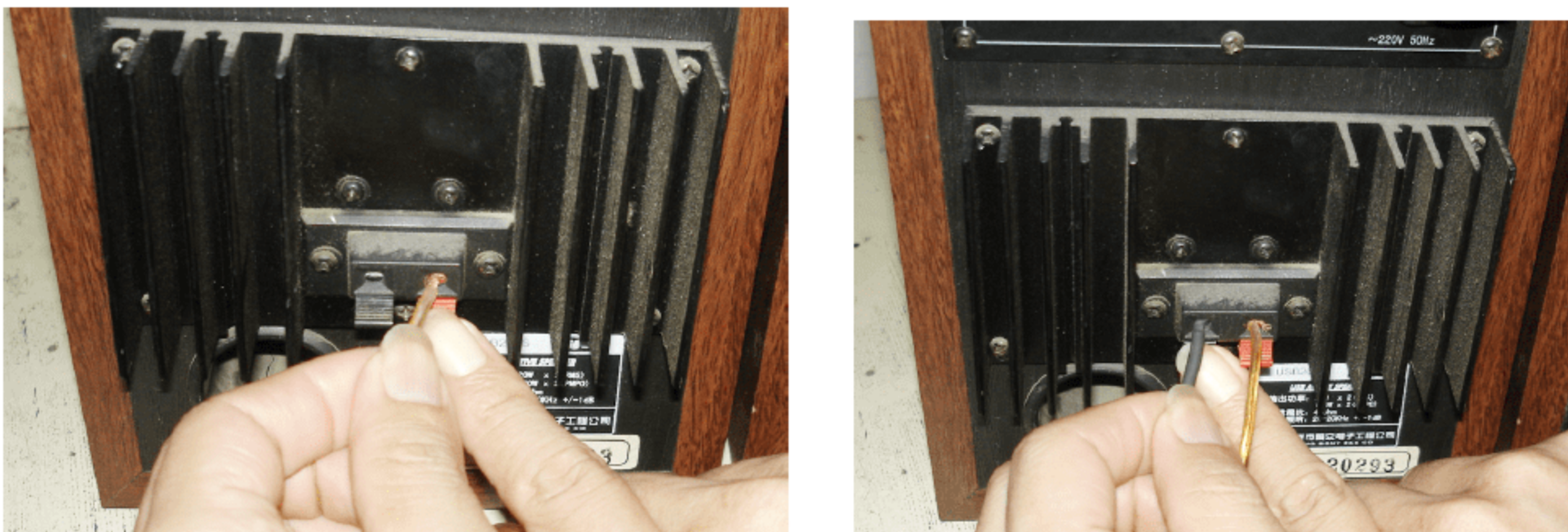
图 2.88 把连接线插入主音箱的卡子中
