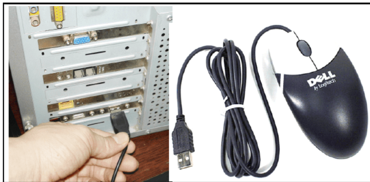
图 2.81 安装 USB 接口的键盘或鼠标
