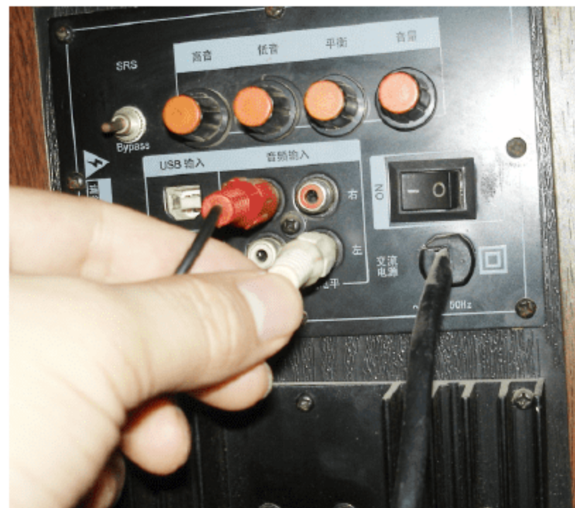
图 2.89 将音频线一端接在音箱的输入口中
