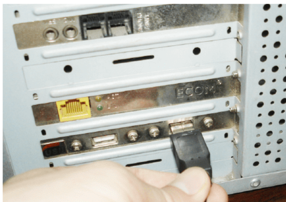
图 2.92 把摄像头连接到计算机
