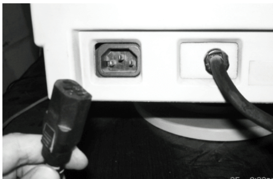
图 2.83 把电源线插入显示器的电源接口中
