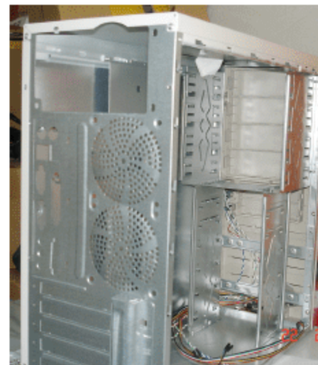
图 2.22 取下机箱的一面盖子
