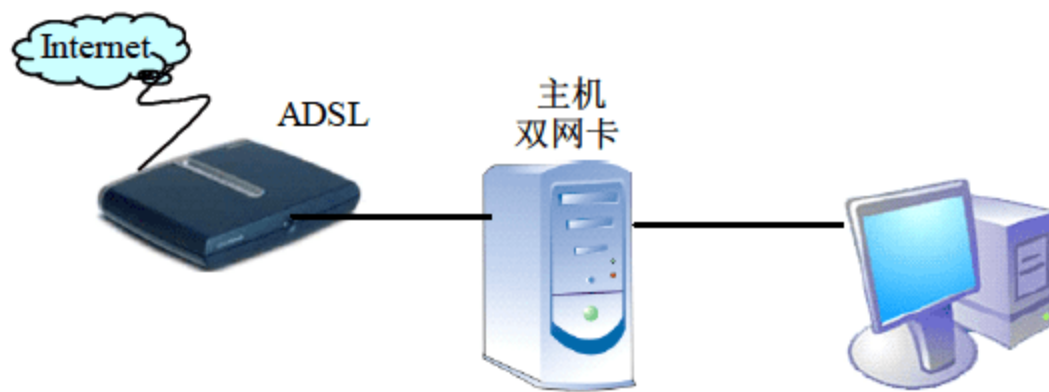
图 11.19 使用网卡连接两台计算机
