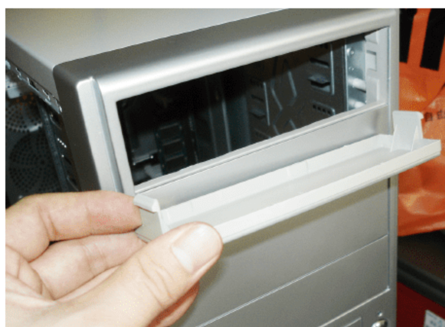
图 2.67 取下一个 5 英寸槽口的塑料挡板
