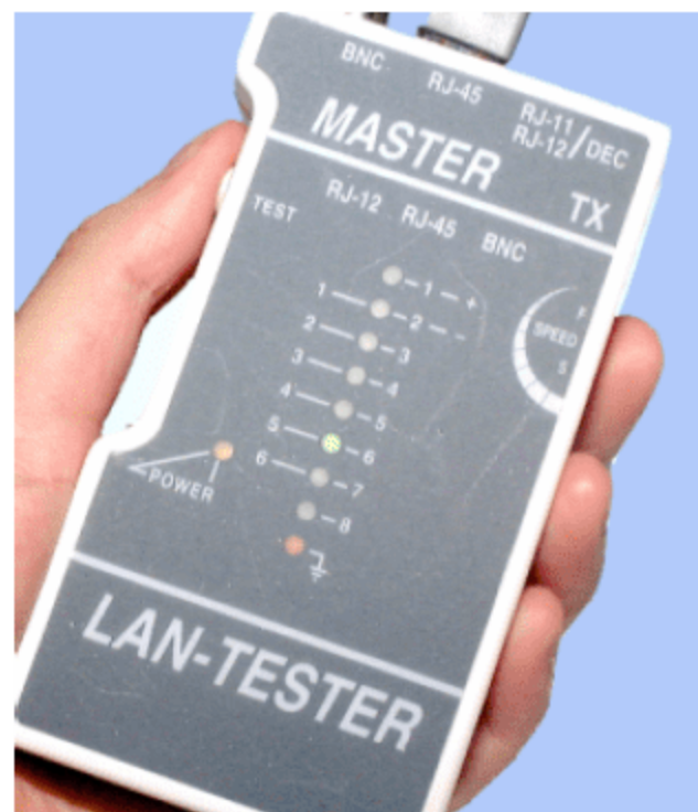
图 10.42 用测试仪测试网线
