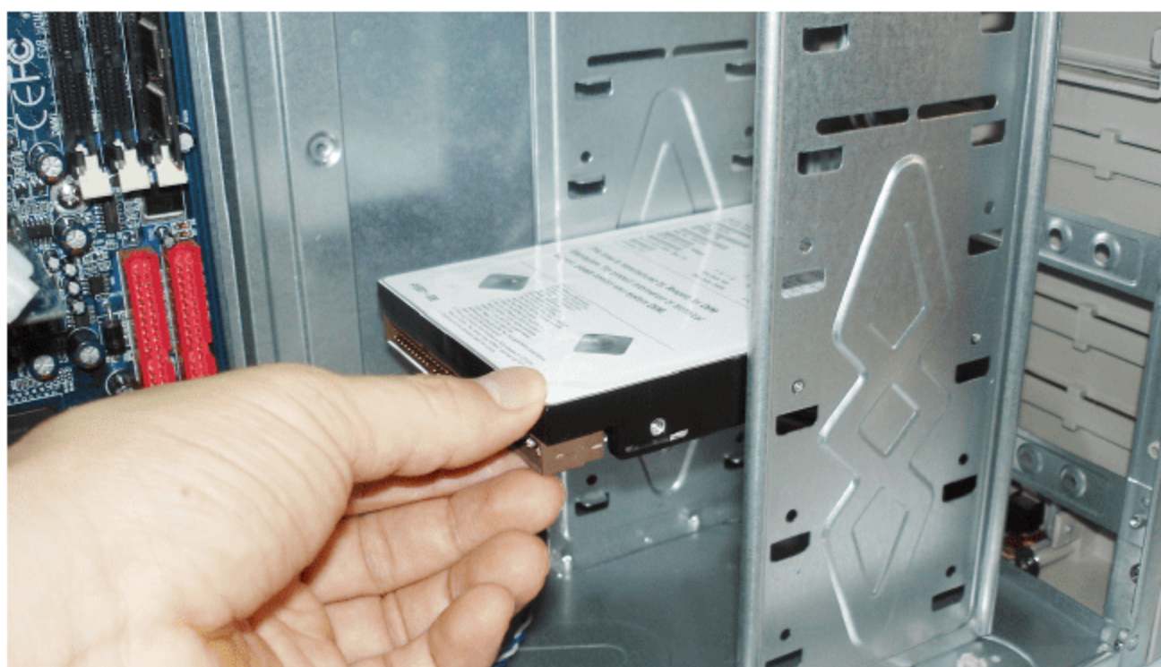
图 2.52 将硬盘安装到驱动器舱内
