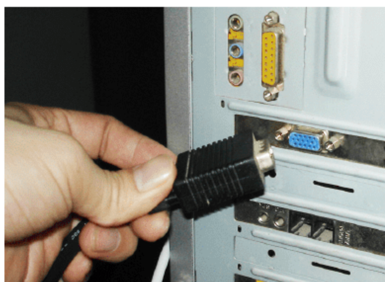
图 2.84 把数据线接到显卡的输出接口中
