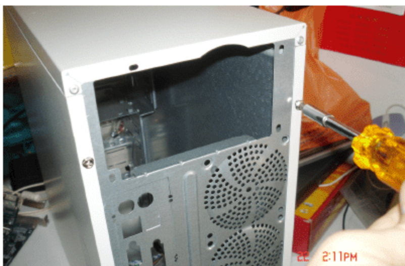
图 2.21 拧下机箱盖上的螺丝
