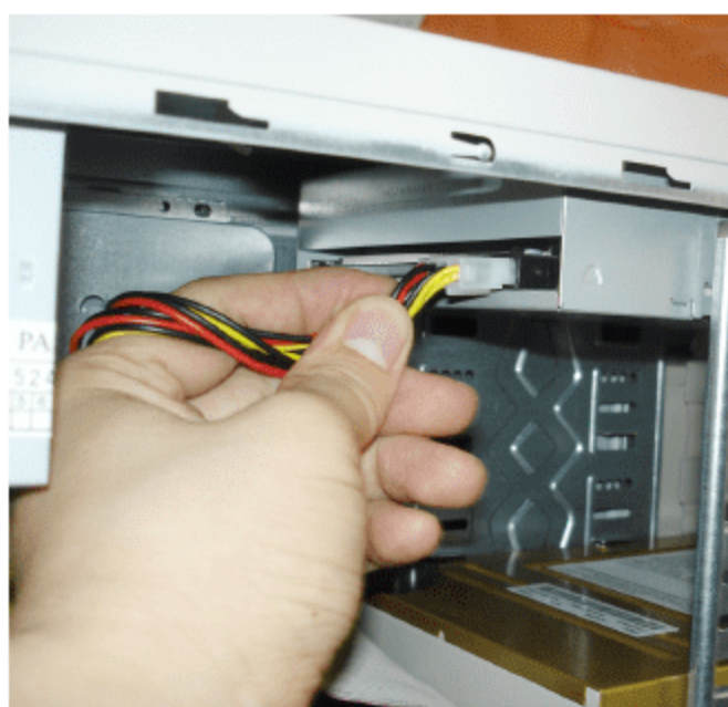
图 2.76 连接刻录机的电源线
