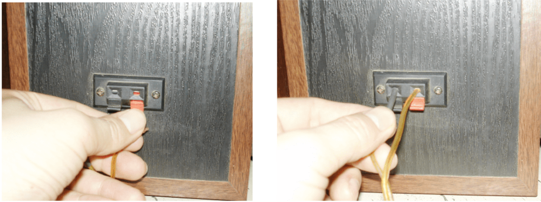
图 2.87 把连接线插入副音箱的卡子中
