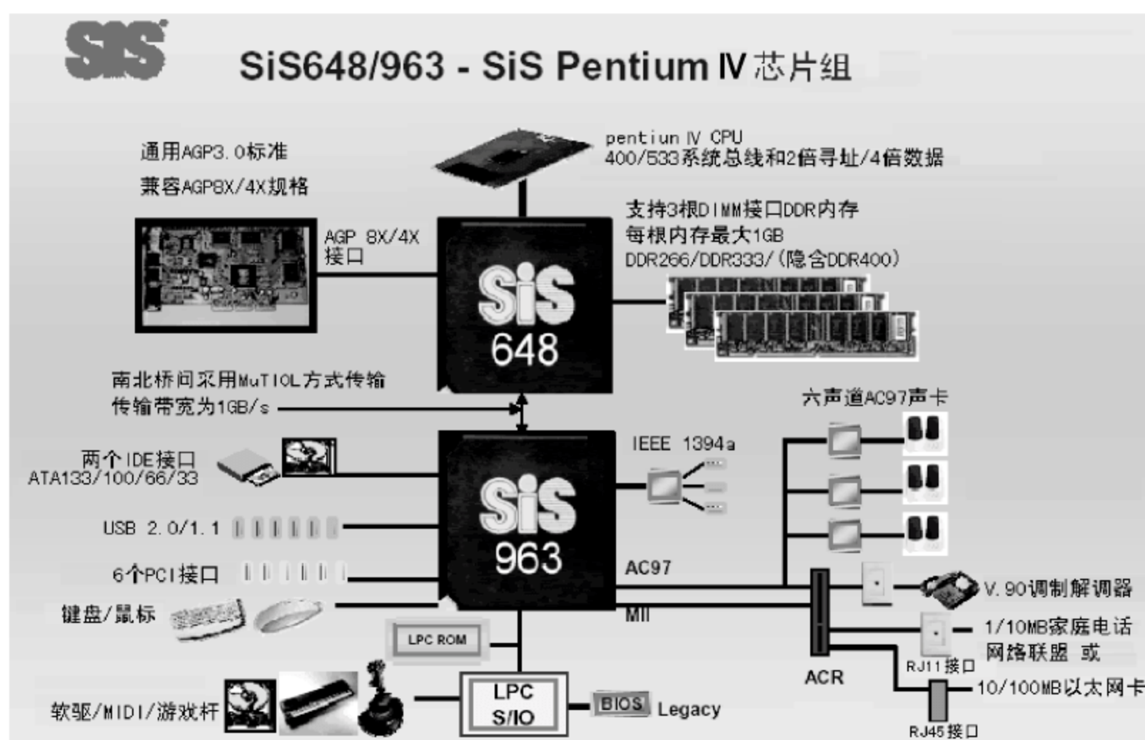
图 7.10 南桥和北桥结构
