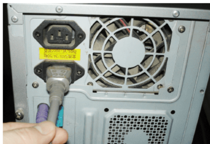
图 2.94 连接到机箱的电源
