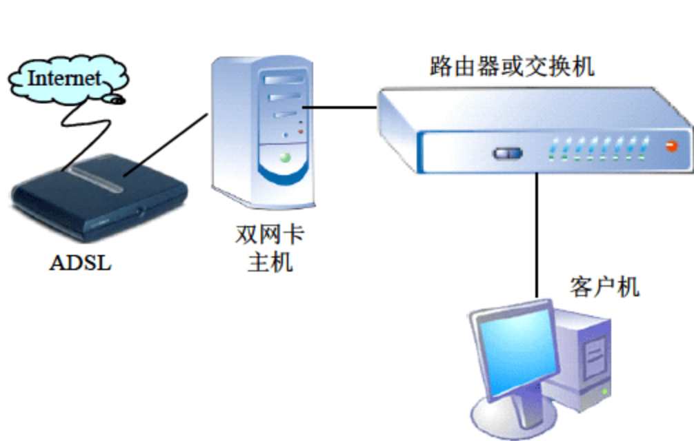
图 11.20 有主机的两台计算机连接
