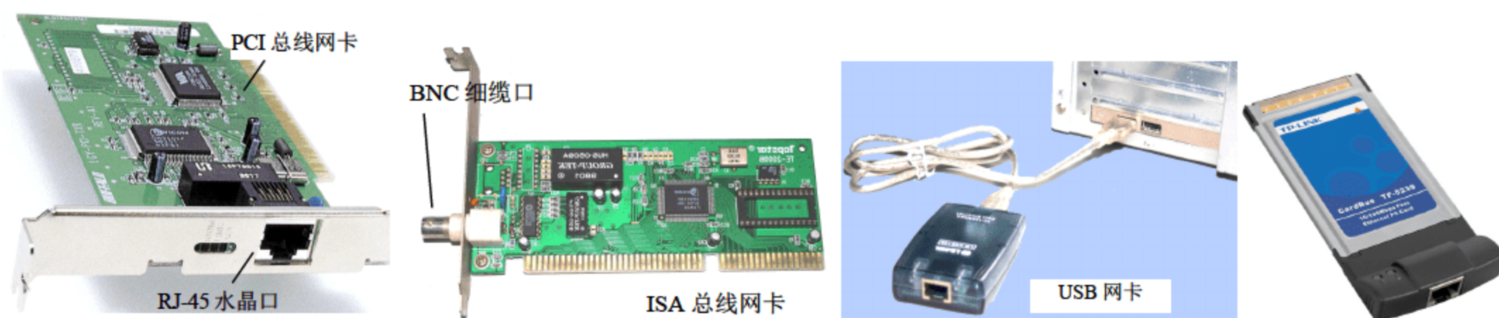
图 10.33 RJ-45 接口网卡、BNC 细缆口网卡、USB 接口网卡和笔记本专用网卡
