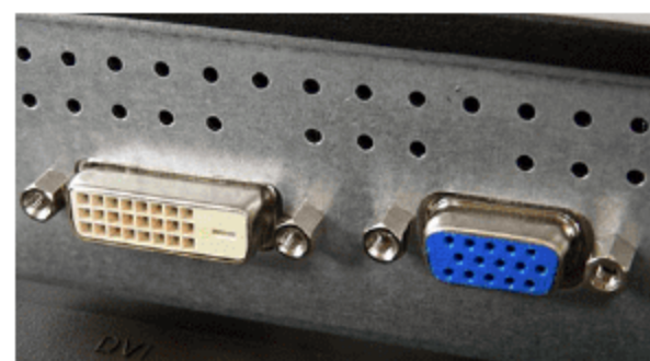
图 9.27 采用 DVI+D-SUB 接口设计的液晶显示器
