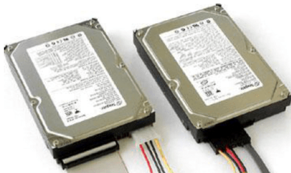
图 8.15 串口硬盘与 IDE 硬盘的连接比较
