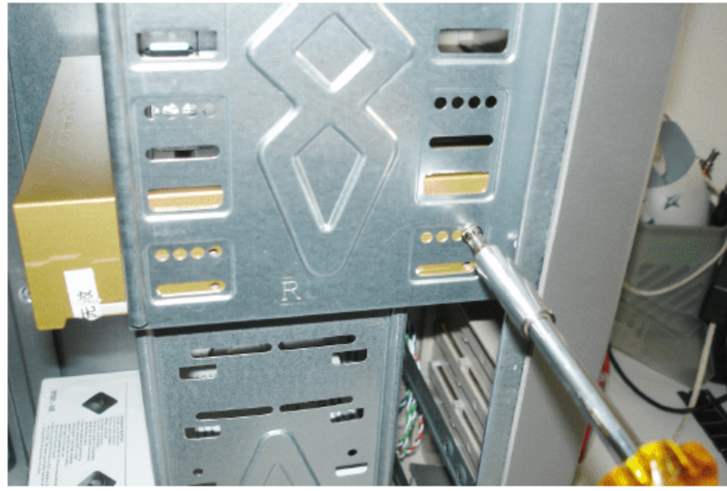
图 2.72 上紧机箱侧面的螺丝
