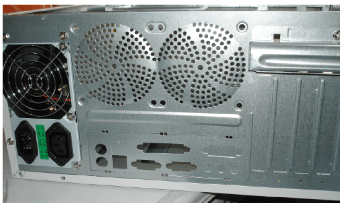
图 2.30 找到挡板上的输入/输出缺口
