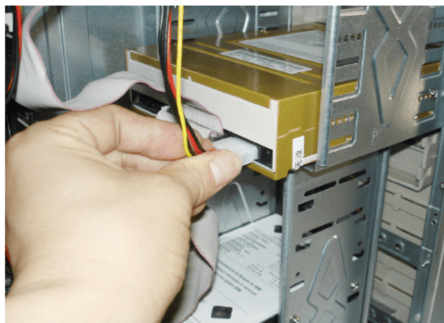
图 2.77 连接 DVD 驱动器的电源线
