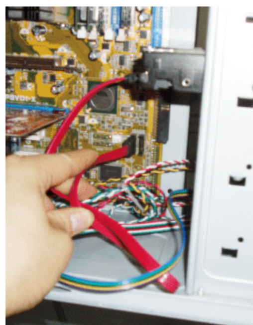
图 2.62 将数据线的另一端连接到主板
