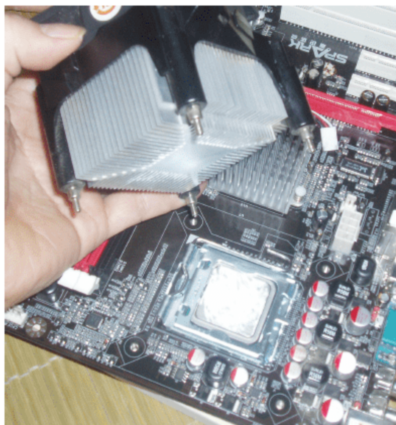
图 2.12 把散热器对准主板固定孔
