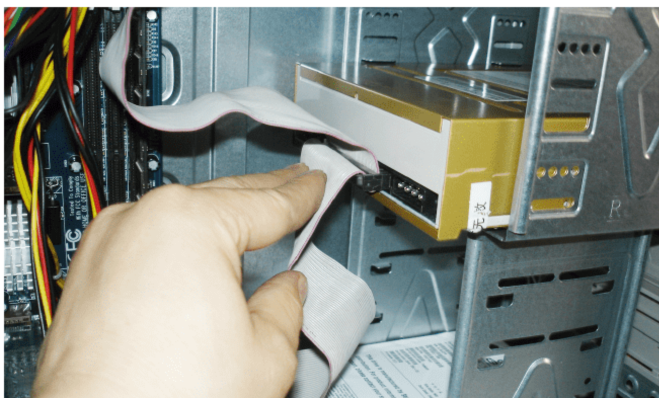
图 2.75 把数据线的中端连接到 DVD 驱动器的 IDE 接口中
