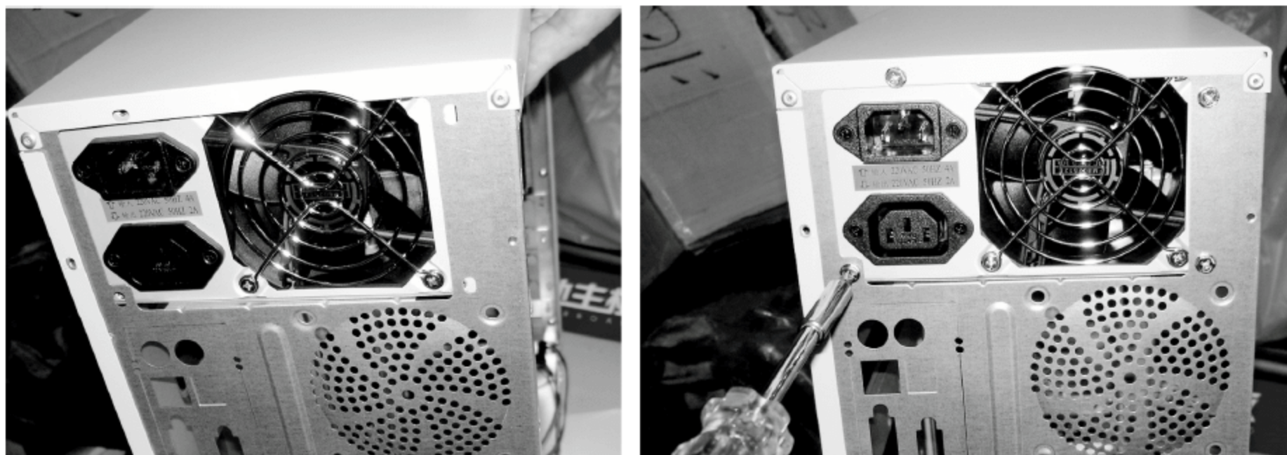
图 2.25 拧紧电源4个角上的螺丝
