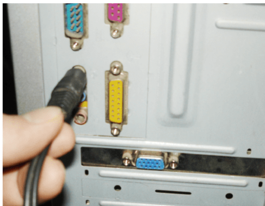
图 2.90 将音频线连接在声卡输出接口中
