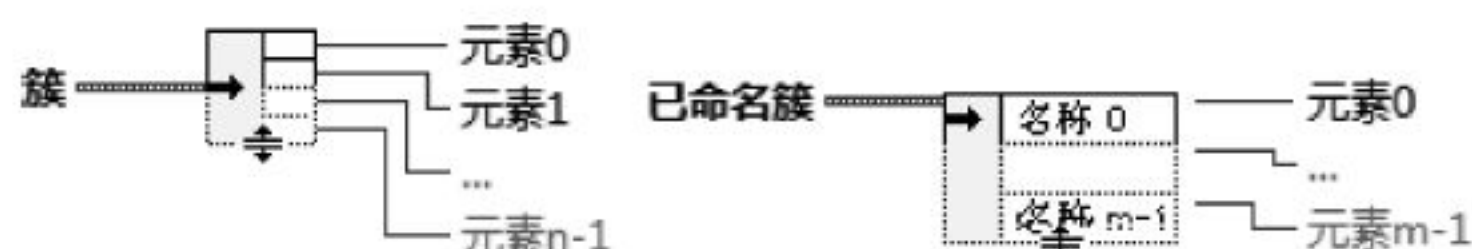
图 3.62 解除捆绑和按名称解除捆绑函数
