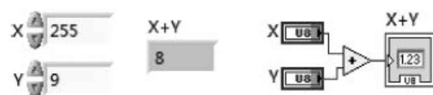
图 3.10 数据溢出前面板和程序框图
