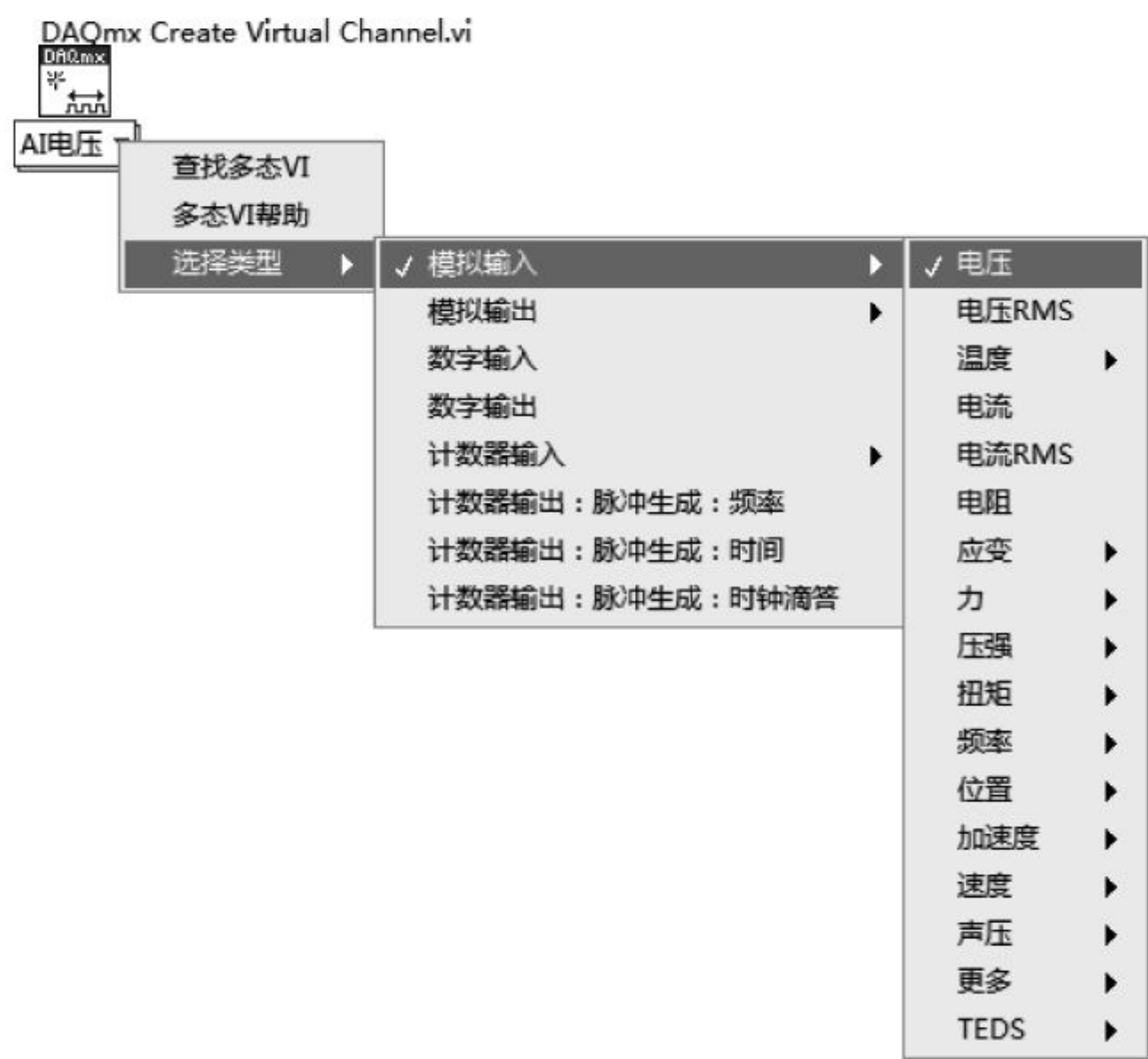
图 10.21 DAQmx 创建虚拟通道类型选择
