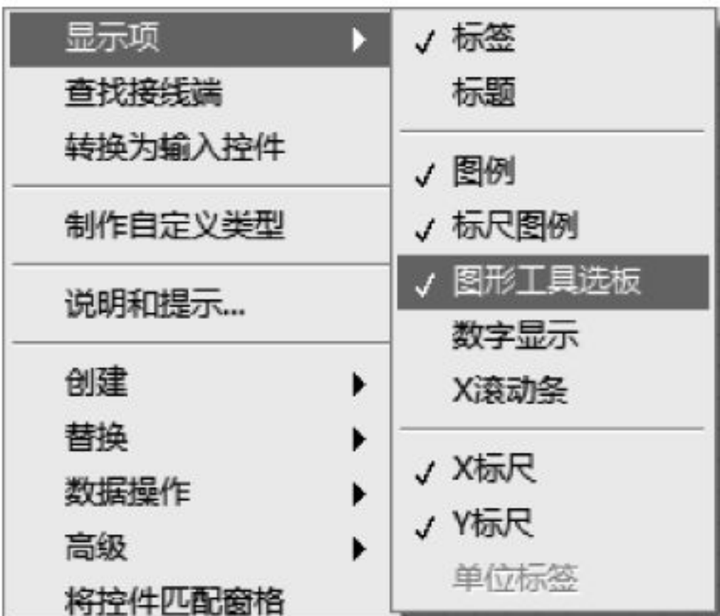
图 5.2 波形图表显示项菜单
