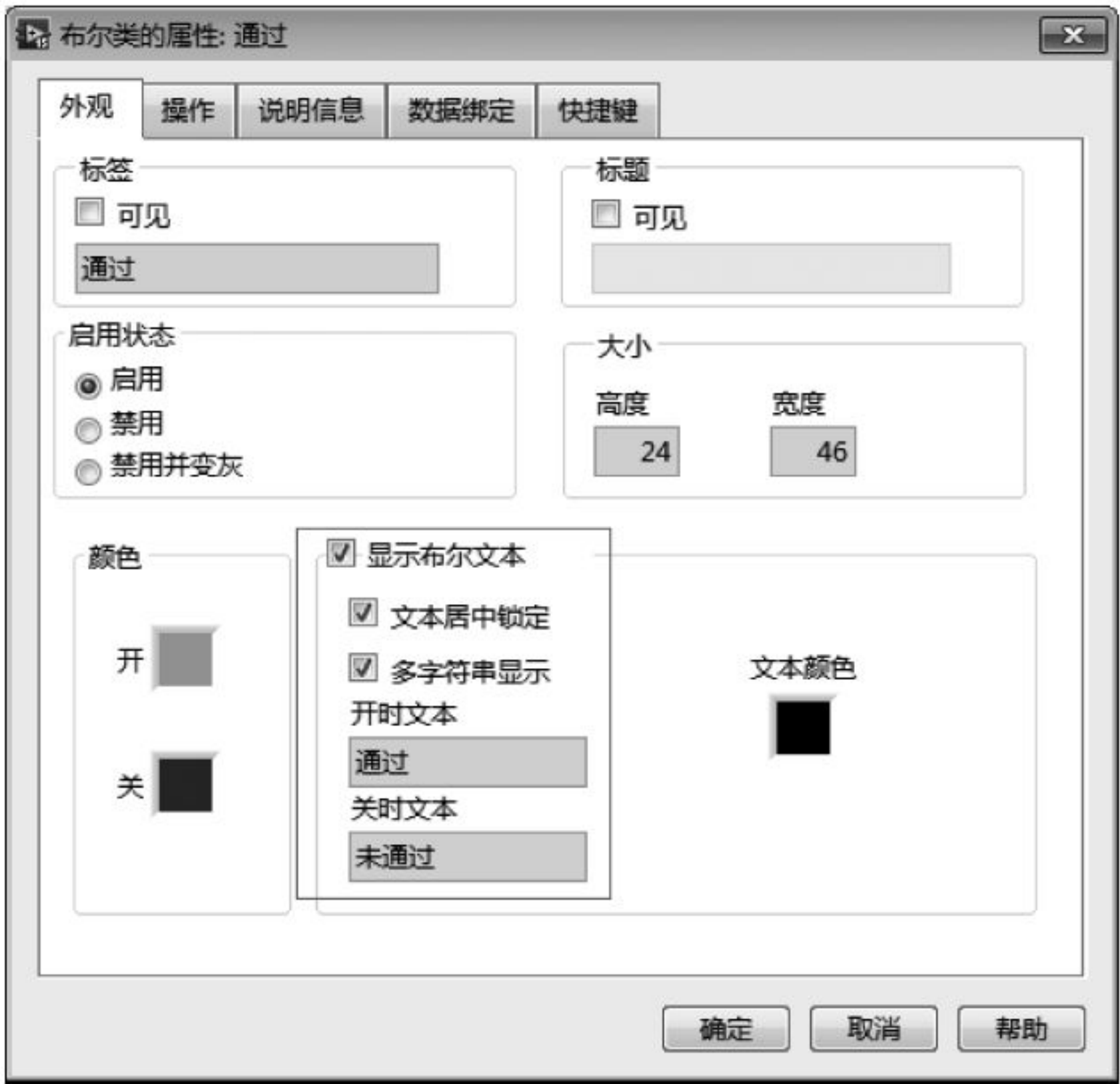
图 2.18 布尔控件属性对话框
