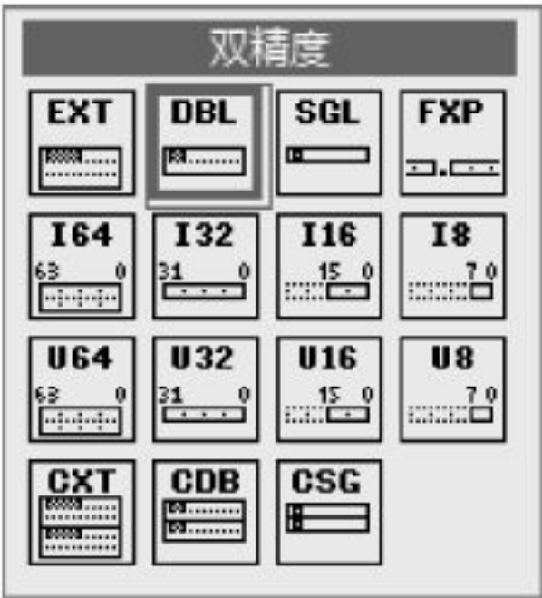
图 3.3 数值型的数据精度类型
