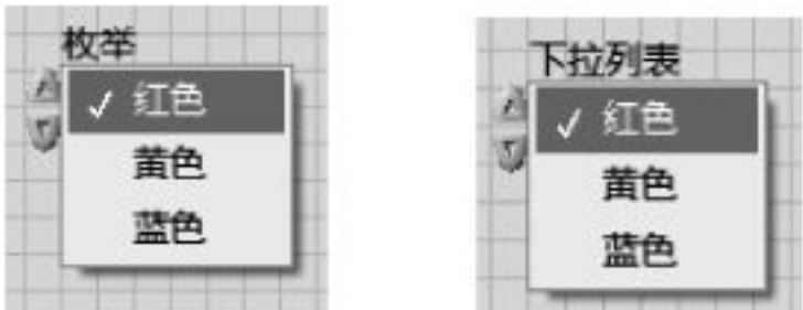
图 3.31 枚举控件和下拉列表的外观
