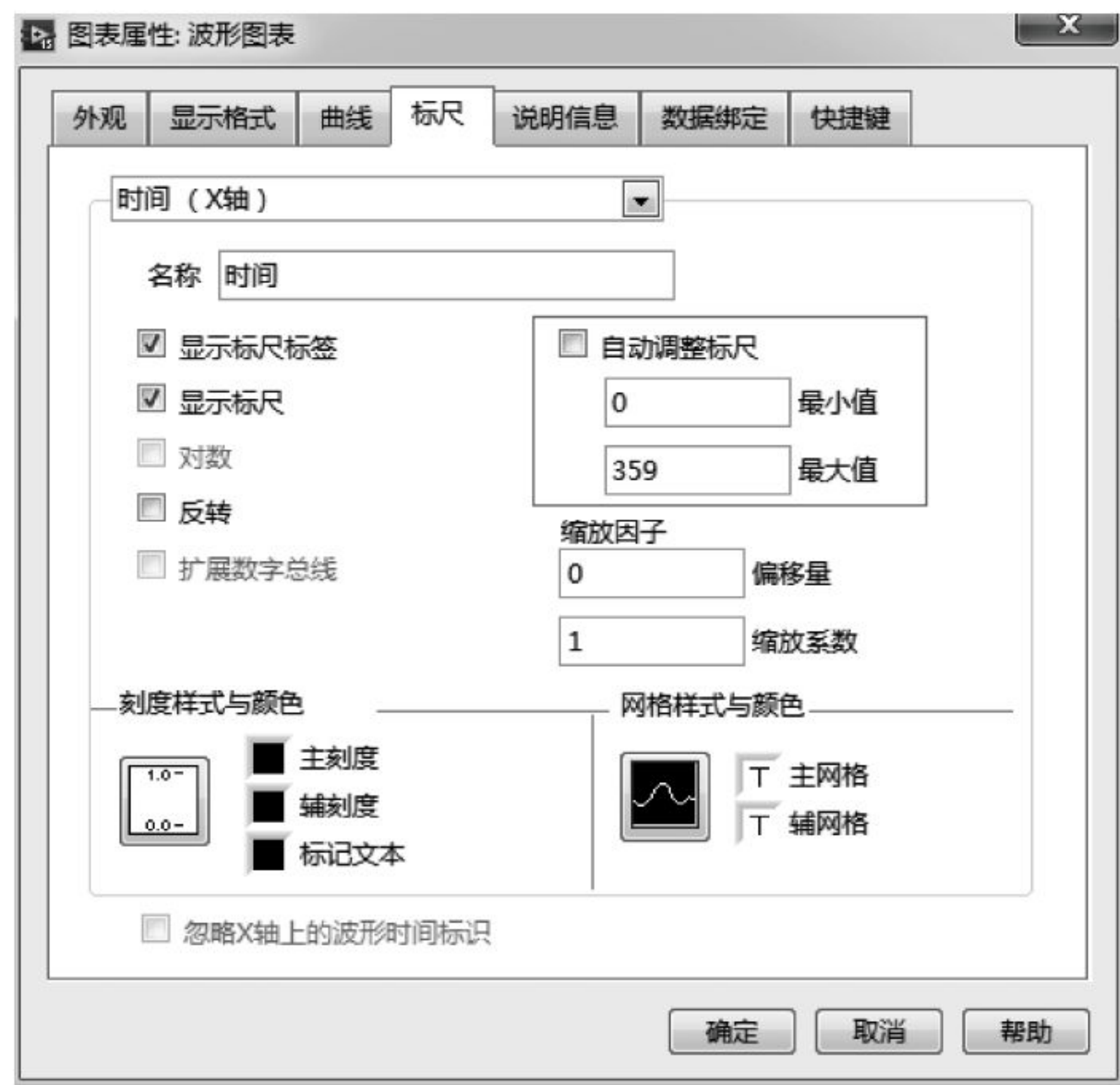
图 5.12 标尺设置对话框
