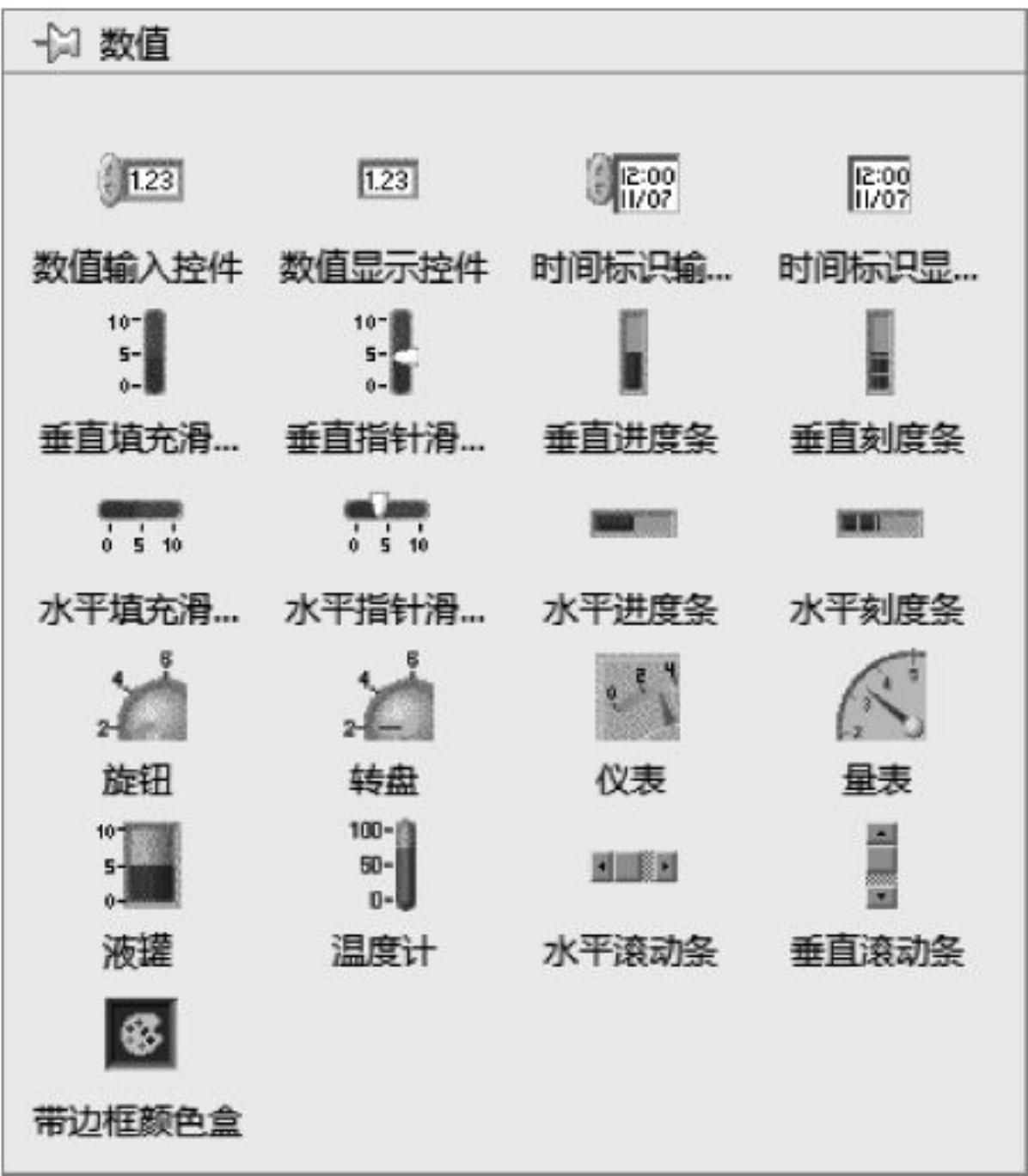
图 3.1 前面板中的数值控件
