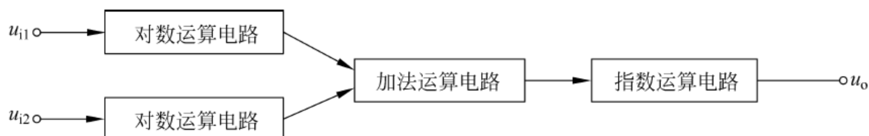
图 3-23 利用指数和对数运算电路实现乘法运算的电路框图
