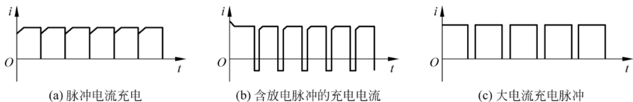
图 10-98 常用充电电流波形
