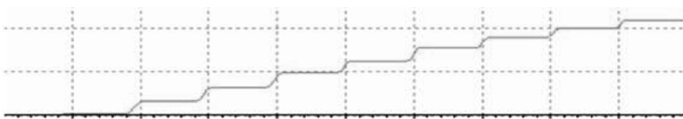
(f) v_{C5} 的波形[水平轴(时间轴)的刻度均为20ms, 垂直轴(电压轴)的刻度为5V/每格]
