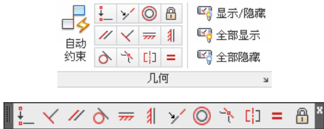
图 3-50 “几何约束”面板及工具栏
