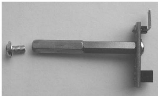
图 10-4 QTI 传感器固定到铜螺柱一端
