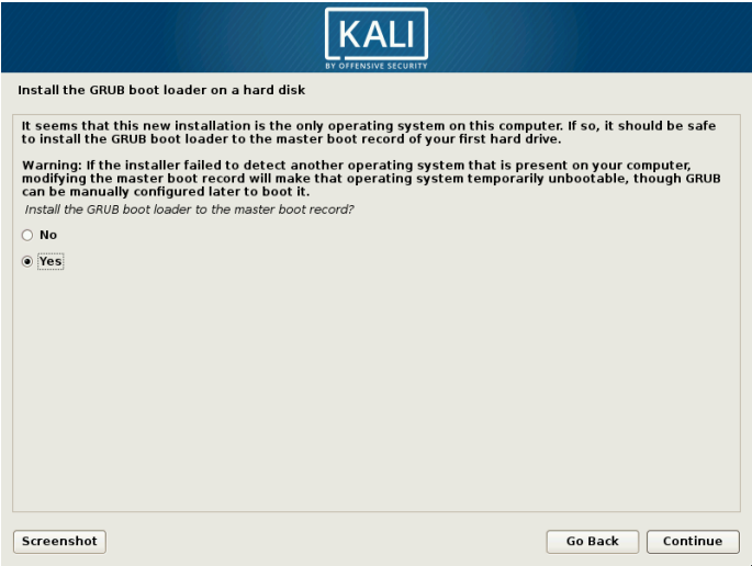
图4.17 在硬盘上安装GRUB引导加载程序
