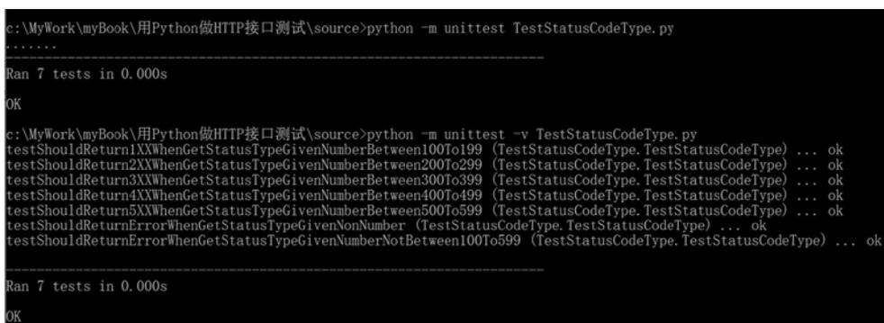
图 9.9 通过命令行运行的 Test StatusCode Type
