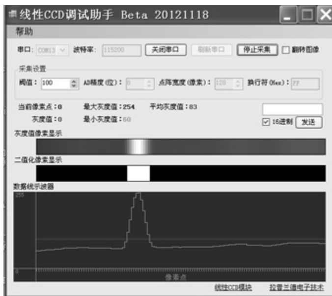
图 9.13 CCD 调试助手测试的路径灰度效果
