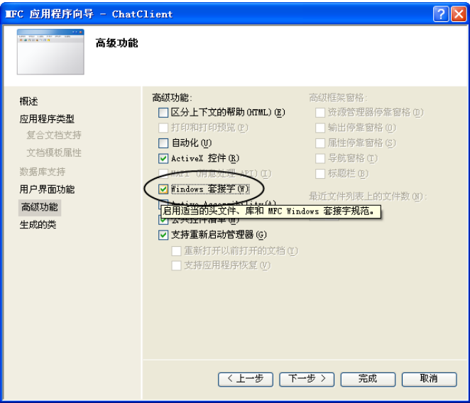
图 2.6 在工程中使用 Windows 套接字
