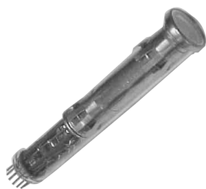
图 5.1 光电管的外形和结构
