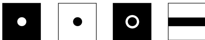
图 6.1-11 四种二元振幅滤波器
