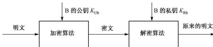
图 4.1 基于公钥密码算法的加解密过程
