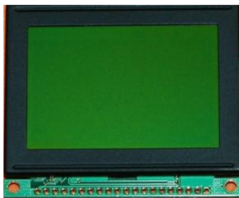
图 10-5 FM12864F-6 液晶实物图
