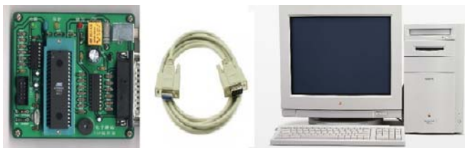
图 9-1 单片机与 PC 机串口连接
