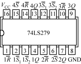
图 5.5 74LS279 的引脚图
