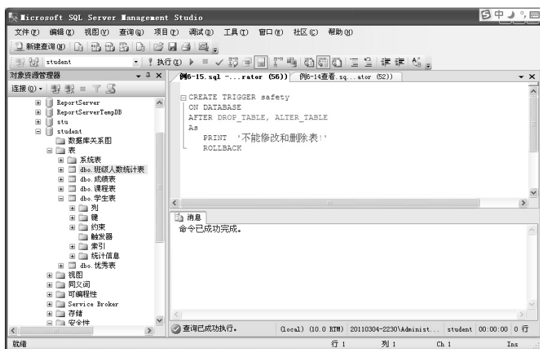
图 6-32 创建 DDL 触发器
