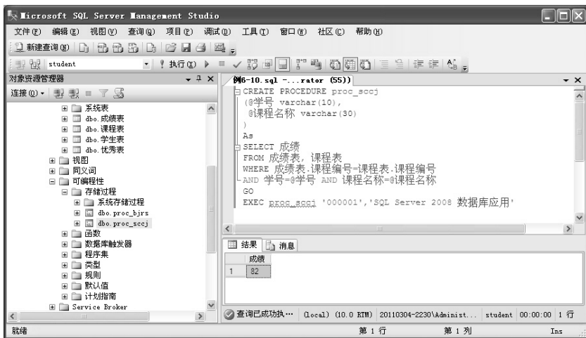
图 6-19 创建带参数的存储过程
