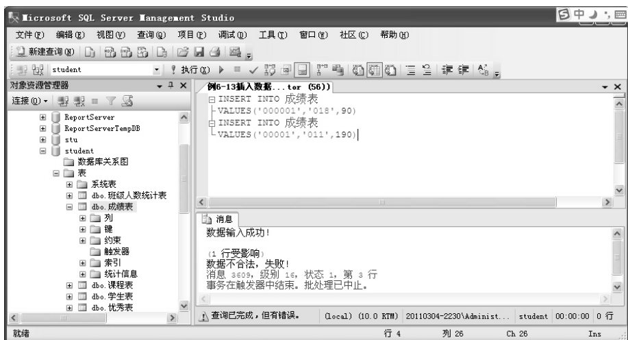
图 6-27 插入记录测试触发器
