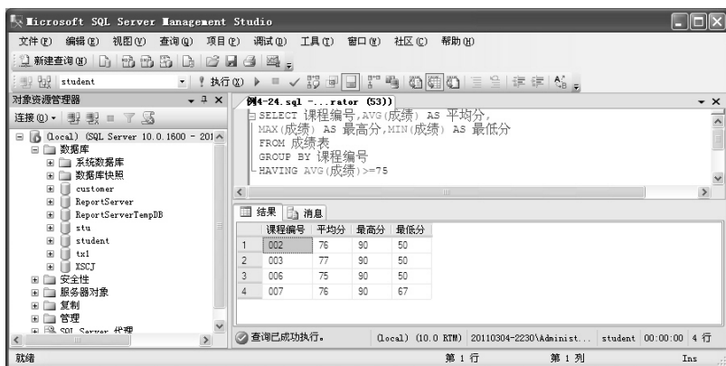
图 4-25 分组后使用 HAVING 筛选查询结果
