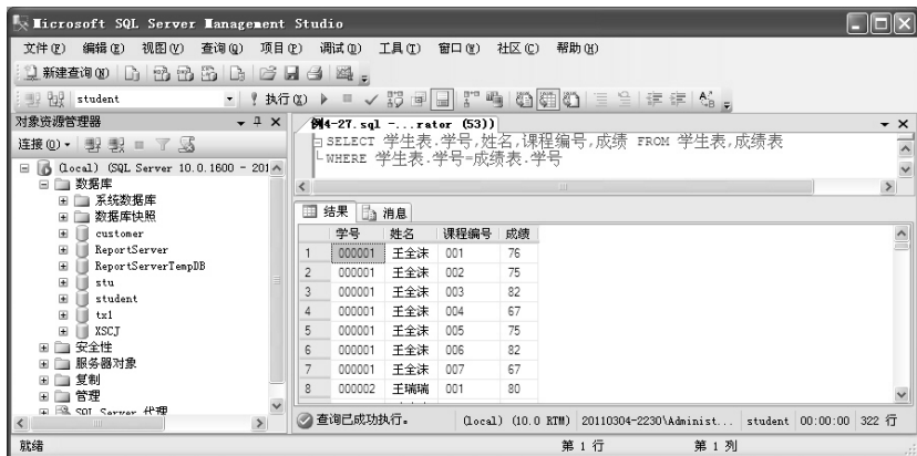
图 4-28 使用 WHERE 子句实现连接查询
