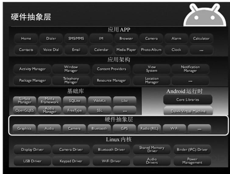
图 2-3 安卓系统及其虚拟硬件抽象层
