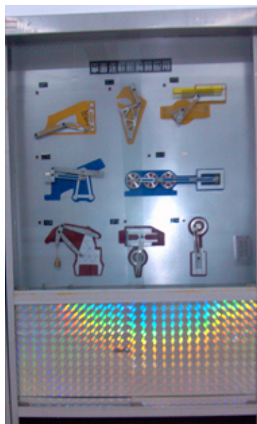
图 2-8 平面连杆机构的应用
