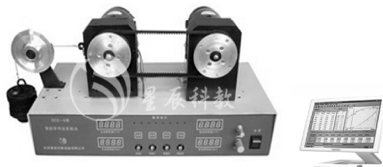
1—从动直流发电机; 2—从动带轮; 3—传动带; 4—主动带轮; 5—主动直流电动机; 6—引绳; 7—滑轮; 8—砝码; 9—拉簧; 10—浮动支座; 11—拉力传感器; 12—固定支座; 13—电测箱; 14—标定杆
