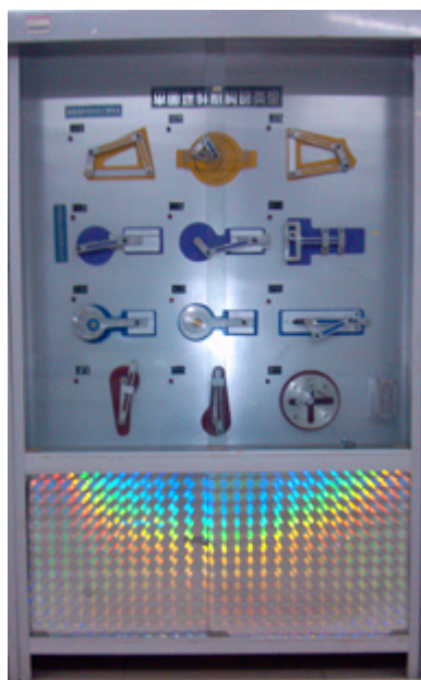
图 2-7 平面连杆机构的类型
