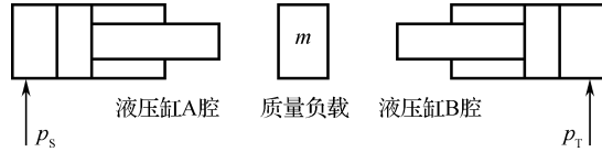
图 8-18 按功率守恒模型所拆分成的元件
